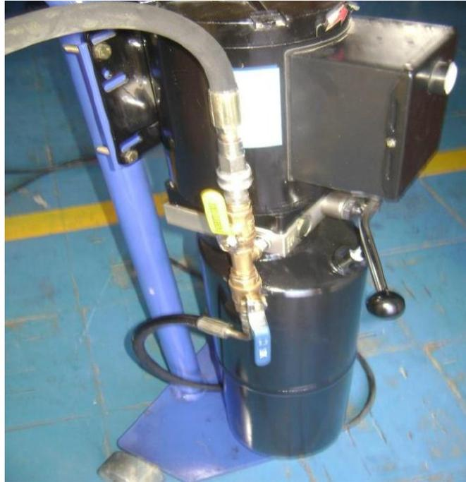
**Figura 26** *Centralita de mando electrohidráulico.*
