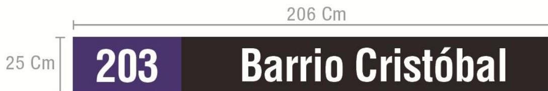
Señal usada en la parte trasera del autobús, al igual que la señal frontal, esta compuesta por el nombre de la ruta y el número de ruta, estando ésta última encajonada en un bloque de color azul para su fácil identificación.
