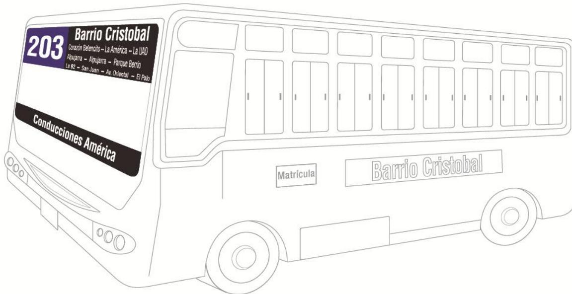
Señal usada en la parte trasera del autobús, al igual que la señal frontal, ésta compuesta por el nombre de la ruta y el número de ruta, estando esta última encajonada en un bloque de color para su fácil identificación
