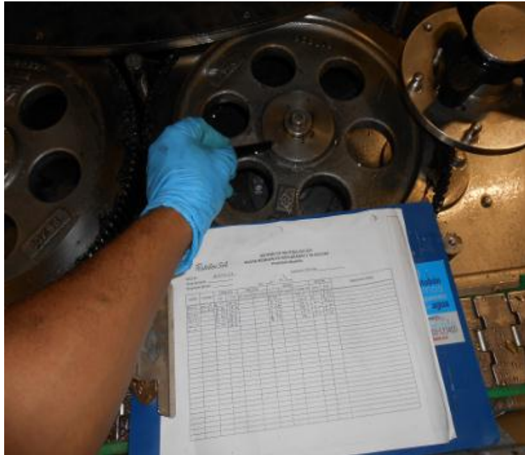
Figura 2. Toma de datos de ajuste de tornillos de la pieza estrella de salida. 3
