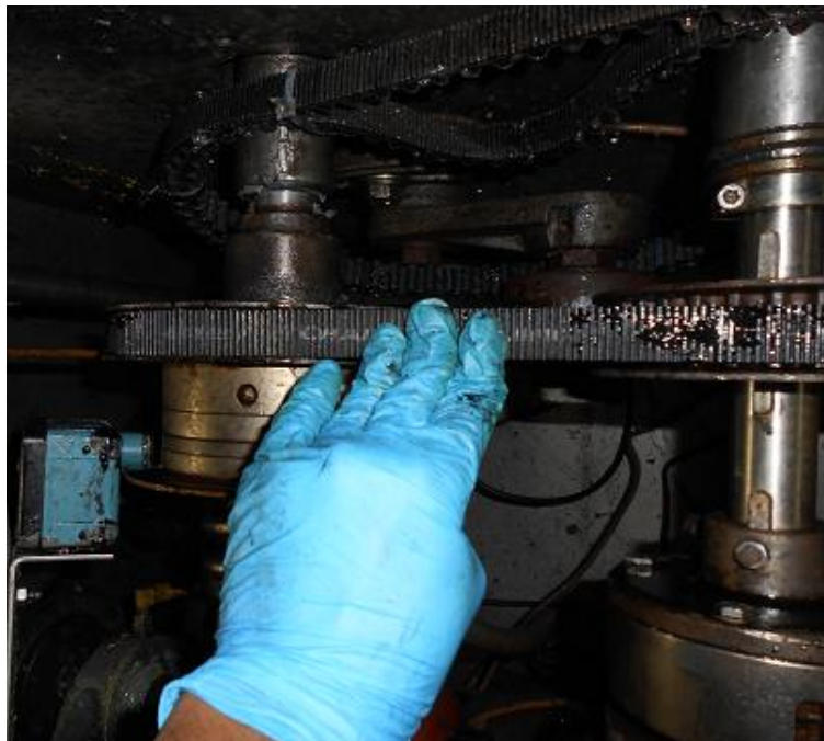
Figura 3. Inspección visual al sistema de transmisión. 4
