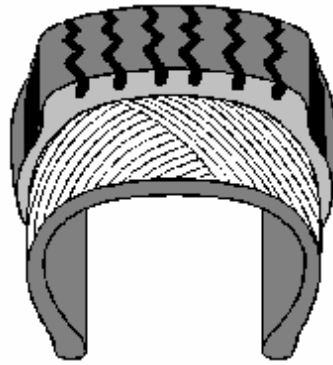
Imagen 12. Sección transversal neumático convencional
