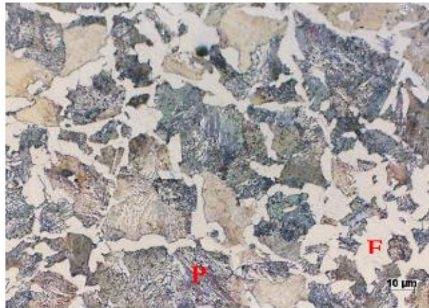
Ilustración 29 Microestructura del acero AISI 1045 estado de entrega (Garzón Torres et al., 2016)
