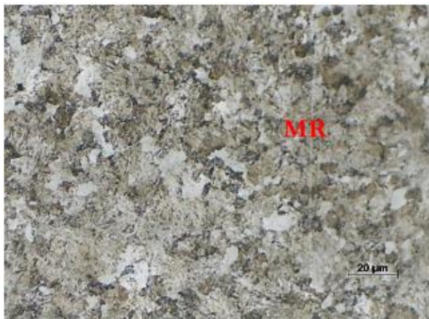
Ilustración 31 Estructura Acero AISI 1045 Revenido por 10 minutos (Garzón Torres et al., 2016)
