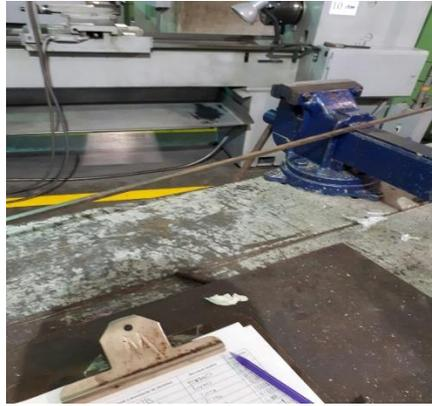
*Figura 10.* Proceso de corte 1. Corte de las fragmentos que se van a utilizar en ensamble de la pieza, los cuales deben ser muy exactos.
