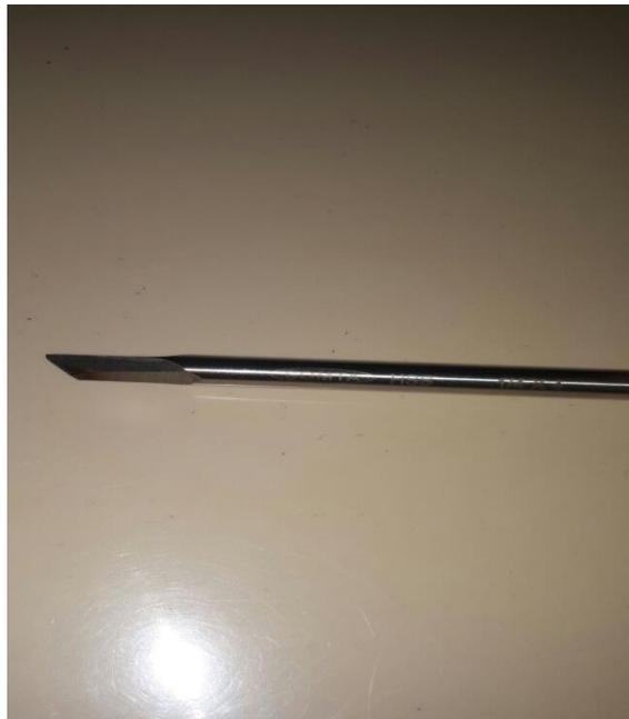
*Figura 9.* Butil. Instrumento que se usa para grabar metales, barra prismática fina y puntiaguda de acero
