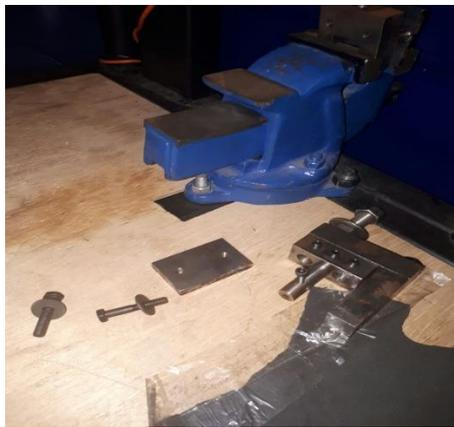
*Figura 14.* Pulido y ensamble 1. Permite realizar los acabados faltantes a la pieza, con el fin de dar los últimos detalles al accesorio.
