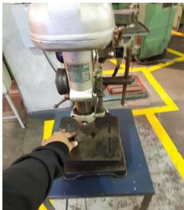
*Figura 12.* Perforaciones 1. Herramienta que permite hacer agujeros a determinada pieza, de forma precisa y donde se requiera.
