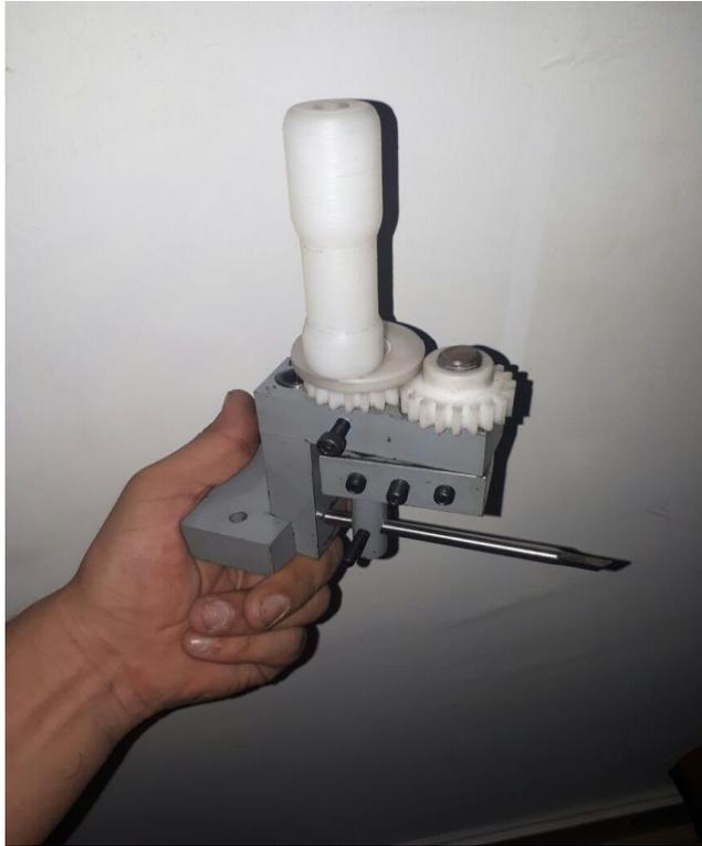
*Figura 1.* Accesorio básico torno para formar curvas.
