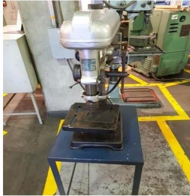
*Figura 13.* Perforaciones 2. Herramienta manipulable que elabora agujeros con precisión.
