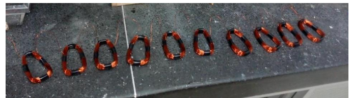
Fig. 5. Fase compuesta por 10 bobinas
