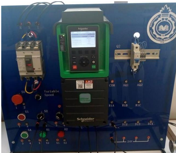
Fig. 13. Módulo variador de velocidad.
