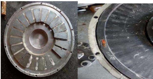
Fig. 3. Daños a imanes y bobina.
