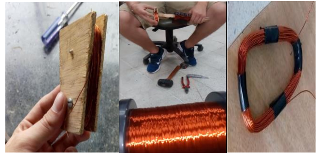
Fig. 4. Diseño y construcción de la bobina
