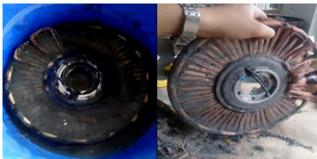
Fig. 20. Remojo y eliminado de resina con removedor de pintura.
