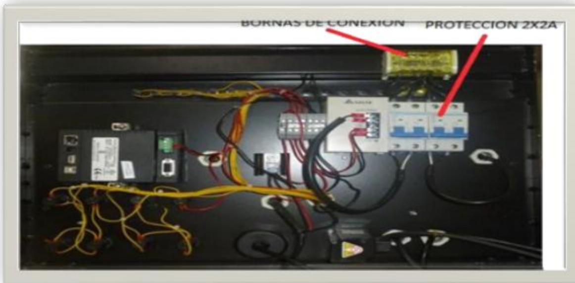
Figura 14. Modulo servomotor implementado parte trasera.
