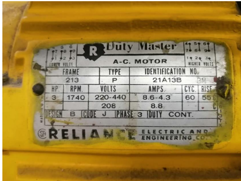
Figura 9. Placa motor de inducción trifásico del túnel de viento de la I. U. Pascual Bravo
