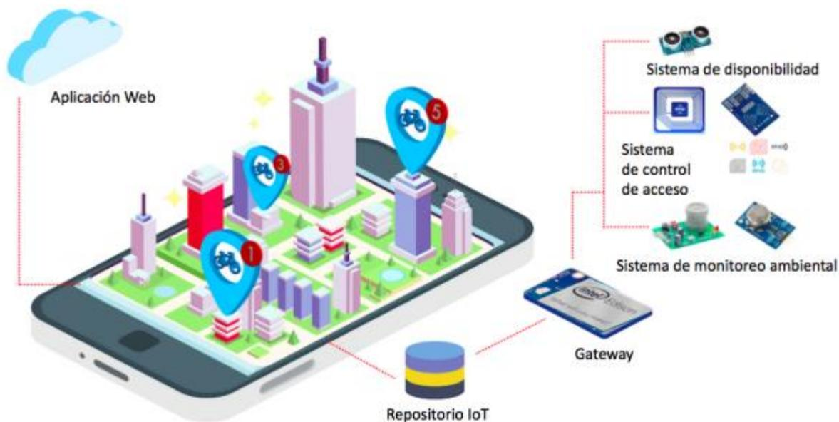
Figura 12. Diseño de sistema IoT de cicloparqueadero inteligente.
