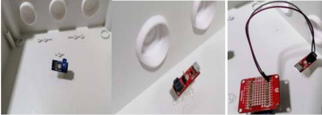
Figura 25. Sensor de Voltaje instalado y pegado con silicona liquida.
