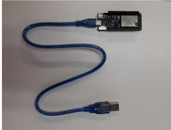
Figura 15. Cable de conexión de módulos
