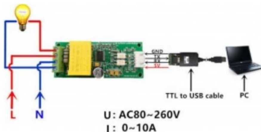
Figura 11. Diagrama de conexión del módulo PZEM 004t
