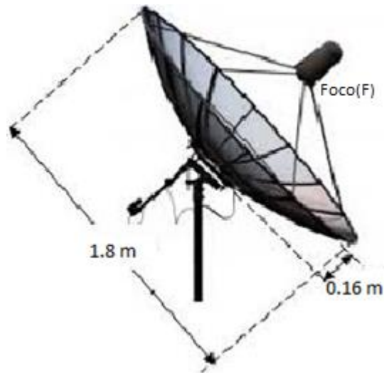
Figura 16 Representación gráfica del disco parabólico
