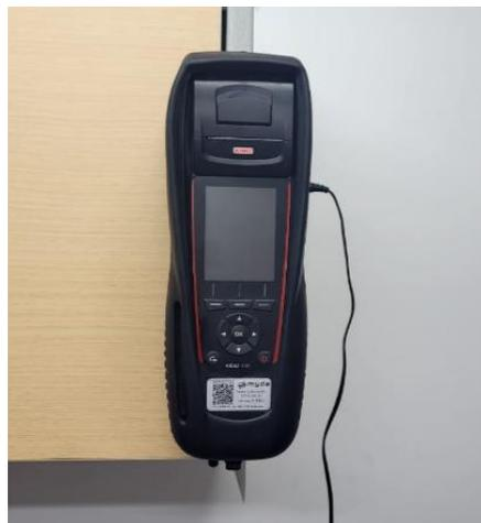
Figura 12. Equipo para el análisis de gases de escape
