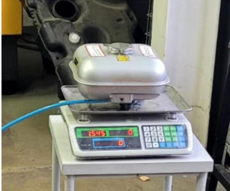
Figura 13. Medición de consumo de combustible, sistema preliminar 1
