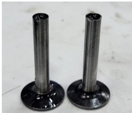
Figura 7. Válvulas averiadas. Problema sobre el final del vástago
