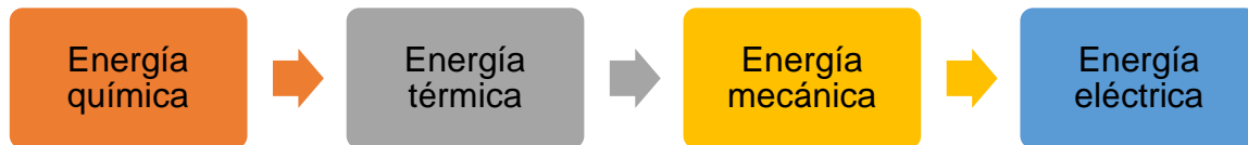
Figura 3: Flujograma de la transformación de la energía en un grupo electrógeno
