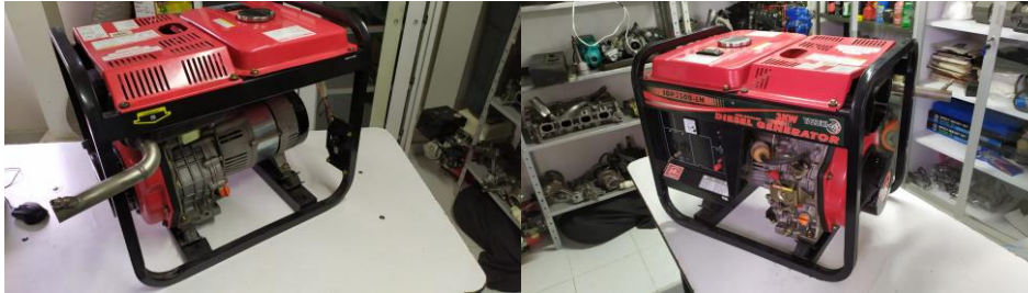
Figura 2. Grupo electrógeno Diesel
