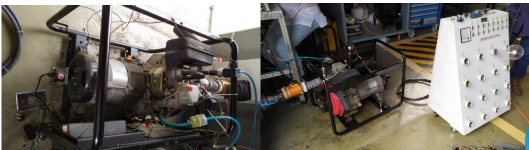
Figura 4. Grupo electrógeno diésel
