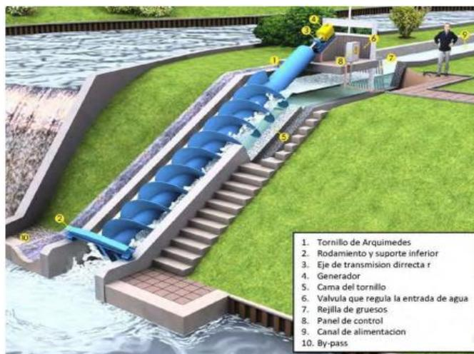
*Figura 10:* componentes del sistema.
