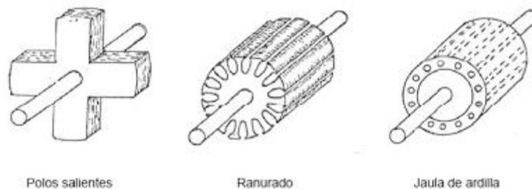
*Figura 12:* Tipos de rotor.
