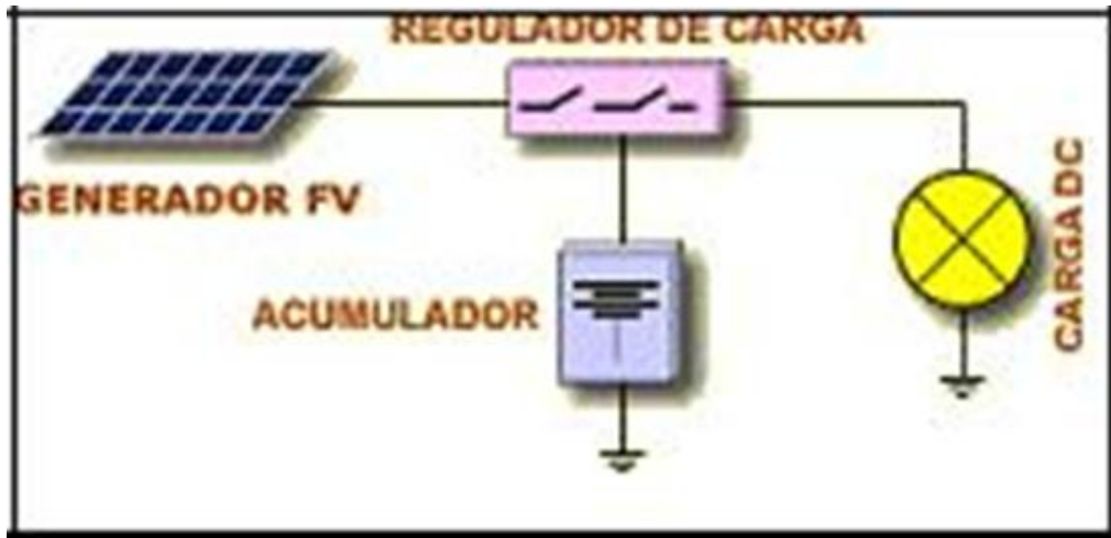
Figura 7. Topología de sistema fotovoltaico para cargas DC
