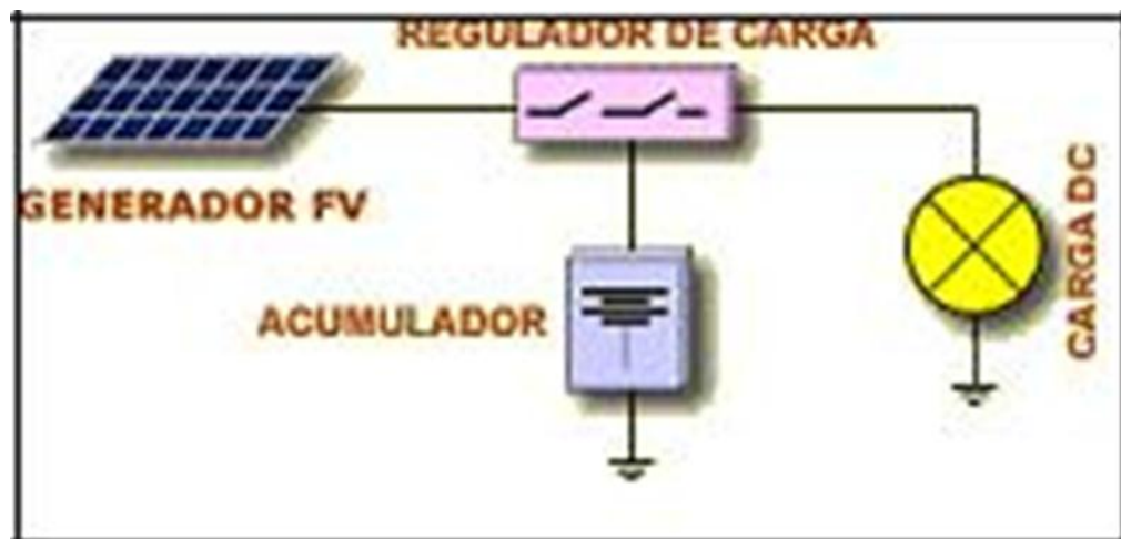
Figura 19 Topologías de sistemas fotovoltaicos para cargas DC
