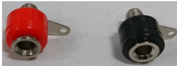
*Figura 27* Conectores tipo banana usado en la construcción del Módulo de Control
