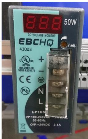
Figura 33 Fuente de alimentación 24Vdc 50W usada en la construcción del Módulo de Control.
