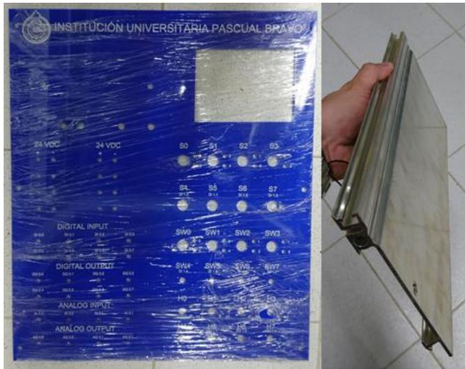
*Figura 37 Tablero acrílico y riel DIM usado en la instalación.*
