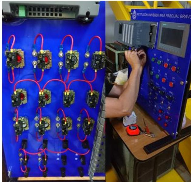
*Figura 38 Cableado de los componentes del módulo de control No.10.*
