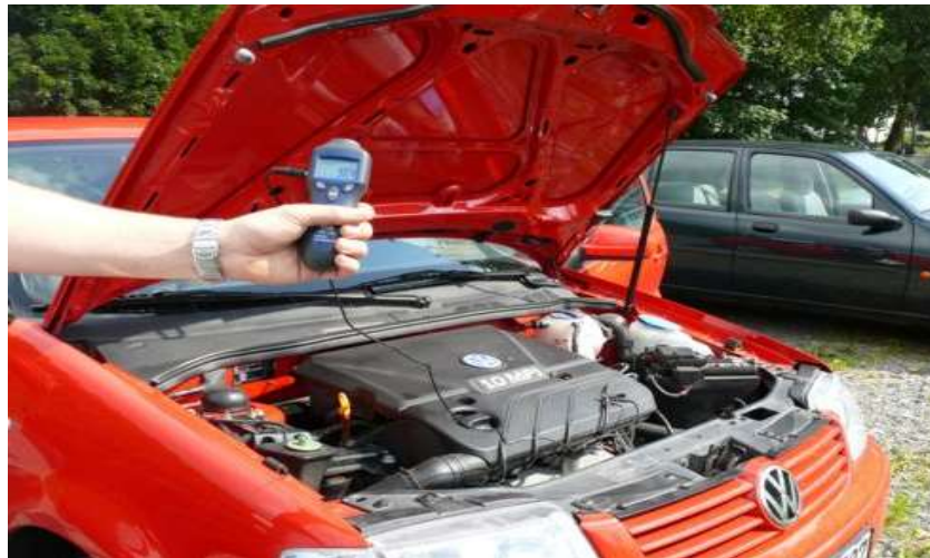
Figura 16. Medidor de RPM para vehículos. Fuente: (PCE, 2018).
