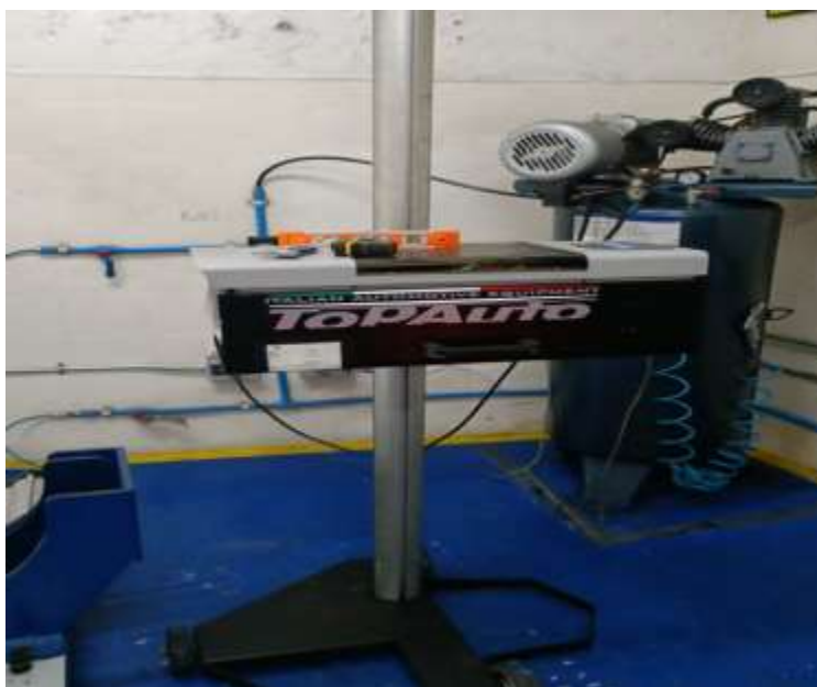
Figura 17. luxómetro marca TopAuto modelo HBA 26 D utilizado en el CDA HANGARES S.A.S
