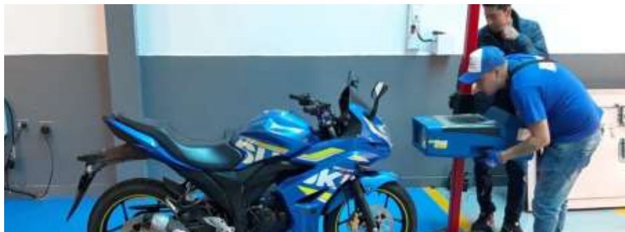
Figura 11. Luxómetro utilizado en la mayoría de CDA. Fuente: (CDAmotociclista, 2022).
