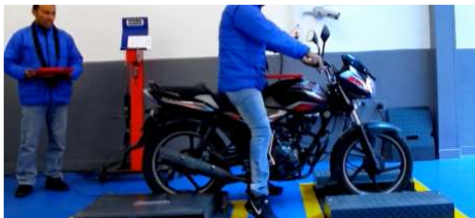
Figura 12. Frenómetro utilizado en CDA. Fuente: (CDAmotociclista, 2022).
