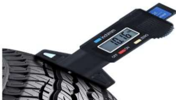
Figura 14. Medidor de profundidad de las ranuras de las llantas. Fuente: (AutoTools, 2019).
