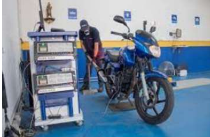
Figura 15. Analizador de gases utilizado en CDA. Fuente: (jDautomotores, 2017).
