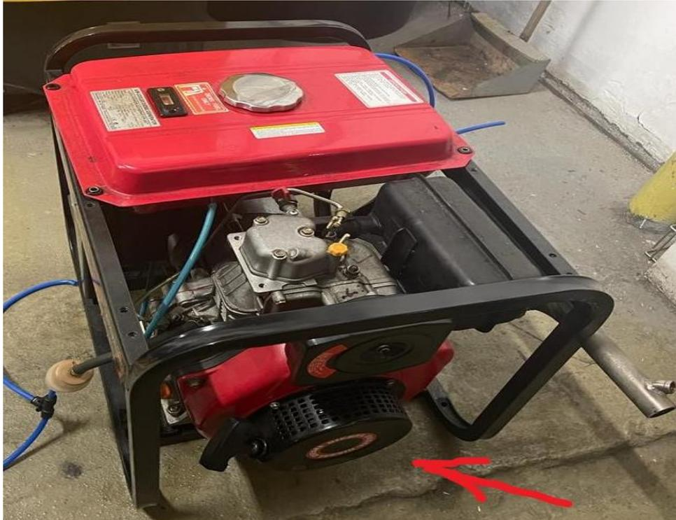
El sistema de encendido de esta planta se basaba en un arranque tipo “yoyo”, el cual requería que el operador en repetidas ocasiones halara de una cuerda de tracción, este a su vez acciona un sistema de polea y resorte que pone en movimiento el sistema, ya que es solidario a la volante del motor. El cable de encendido y el sistema de arranque descrito se evidencia en la Figura 3-2
