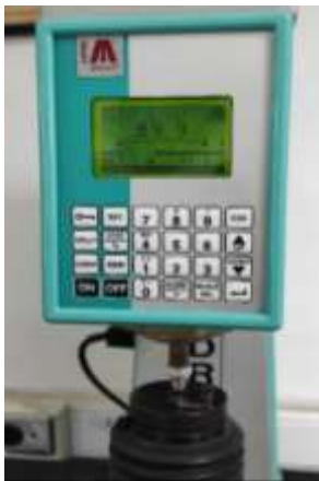
Ilustración 84. Prueba 2 dureza anclaje de hebilla
