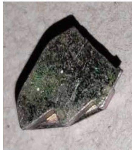
Ilustración 107. Marcas de indentación en el bloqueo del retractor
