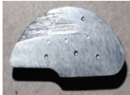
Ilustración 103. Marca del indentador en el eje del retractor
