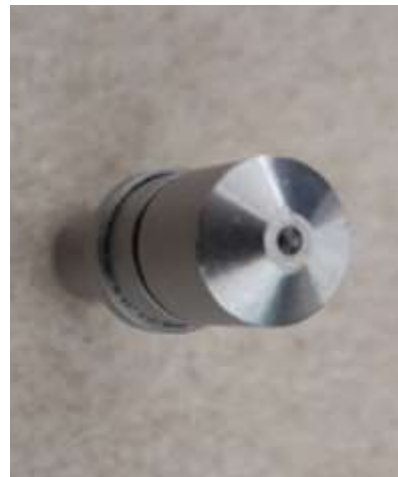
Ilustración 81. Indentador con esfera de 1/16
