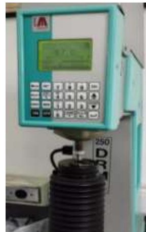
Ilustración 85. Prueba 3 dureza anclaje de hebilla
