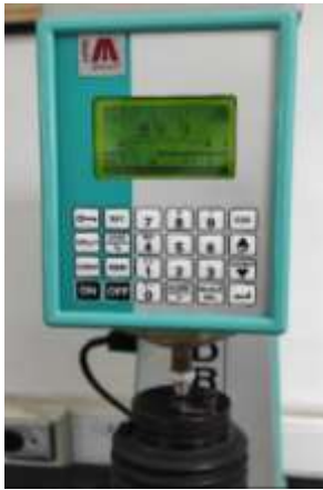
Ilustración 86. Prueba 2 dureza anclaje de hebilla
