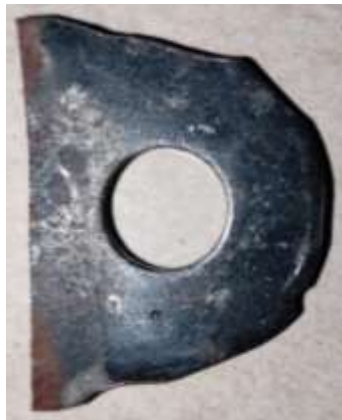
Ilustración 88. Marcas de indentación en anclaje de hebilla
