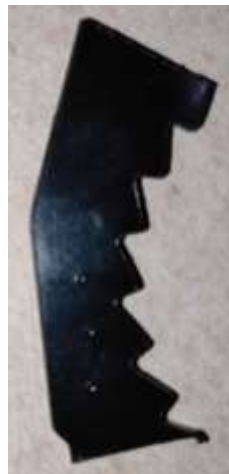
Ilustración 98. Marcas de indentacion en cuerpo del retractor
