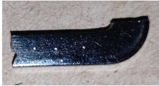
Ilustración 93. Marcas de indentacion en lengüeta
