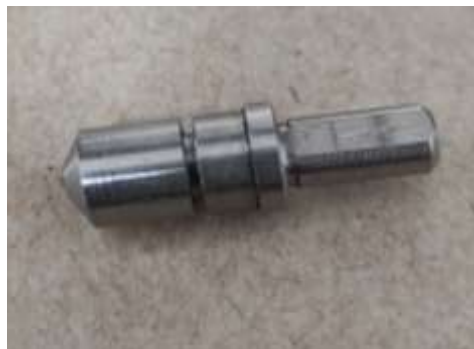
Ilustración 81. Indentador con esfera de 1/16
