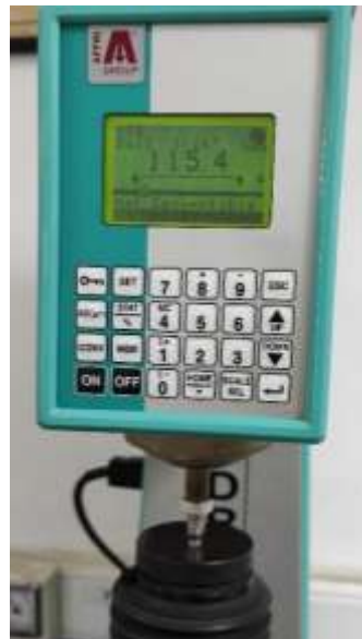
Ilustración 92. Prueba 3 dureza de lengüeta
