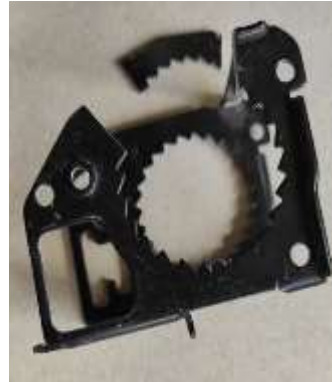
Ilustración 28. Cuerpo del retractor con corte
