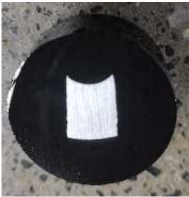
Ilustración 63. Corte del Cuerpo del retractor incluido
