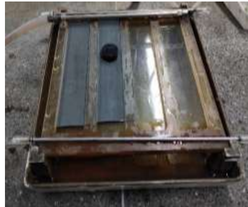
Ilustración 42. Pulidora metelografica manual con la muestra probeta.
