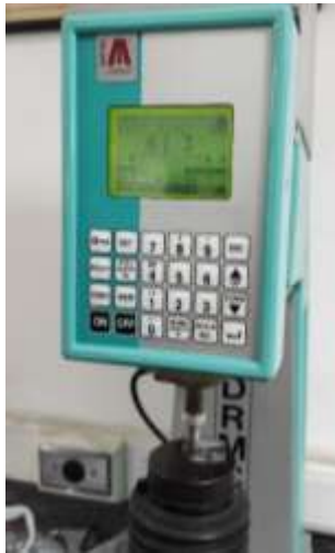
Ilustración 102. Prueba 2 de dureza de eje de retractor
