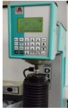
Ilustración 87. Prueba 3 dureza anclaje de hebilla
