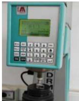
Ilustración 101. Prueba 2 de dureza de eje de retractor
