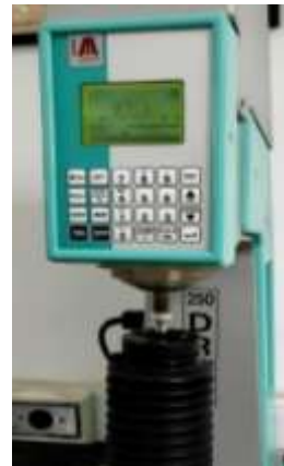
Ilustración 95. Prueba 1 de dureza de Cuerpo del retractor
