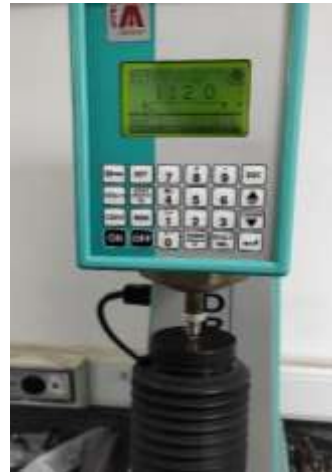
Ilustración 92. Prueba 3 dureza de lengüeta
