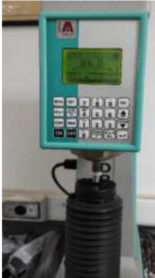
Ilustración 96. Prueba 2 de dureza de Cuerpo del retractor
