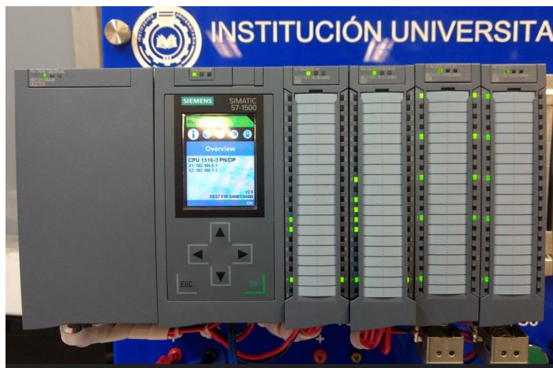
Imagen 12 PLC SIMATIC S7-1500.
