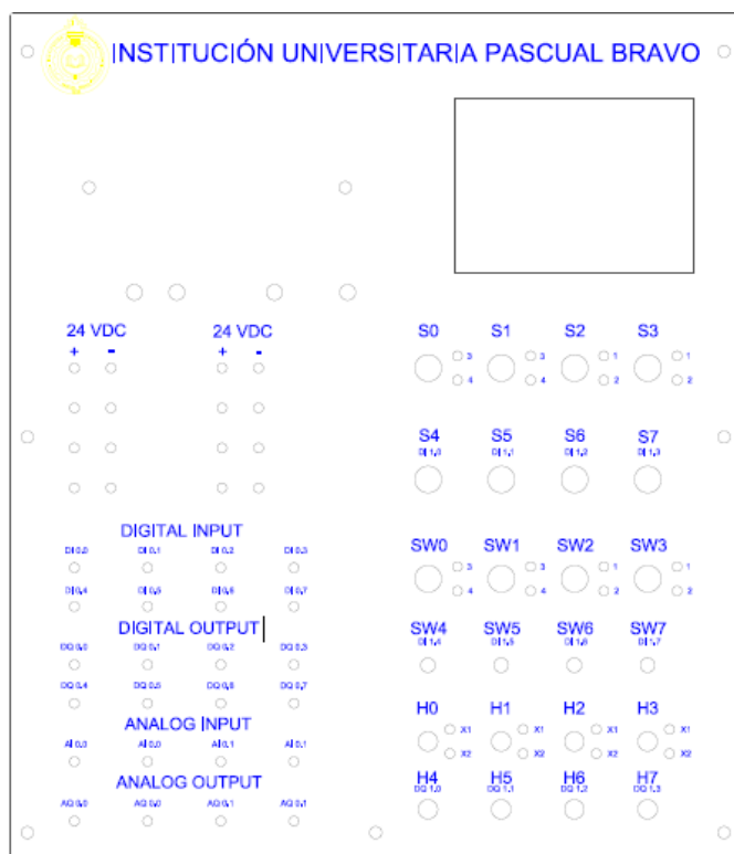
figura 12 Plano tablero modulo Fuente: Diseño propio
