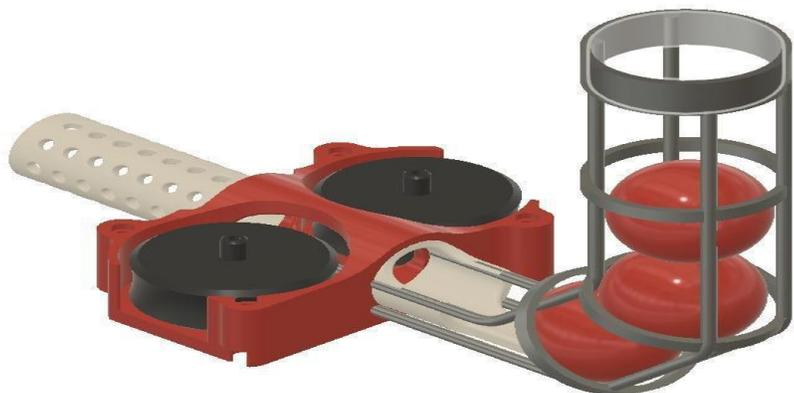
Figura 26: Plano sistema de balones extintores.
