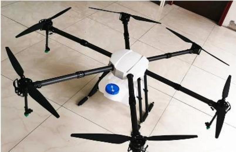
*Figura 20: • Drone de protección agrícola XT90*
