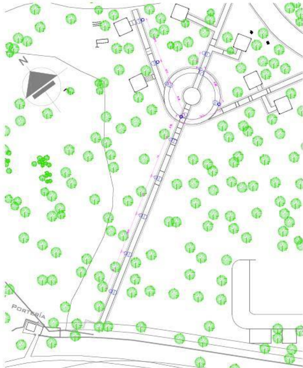
Imagen 1. Planos de montaje y distribución de luminarias
