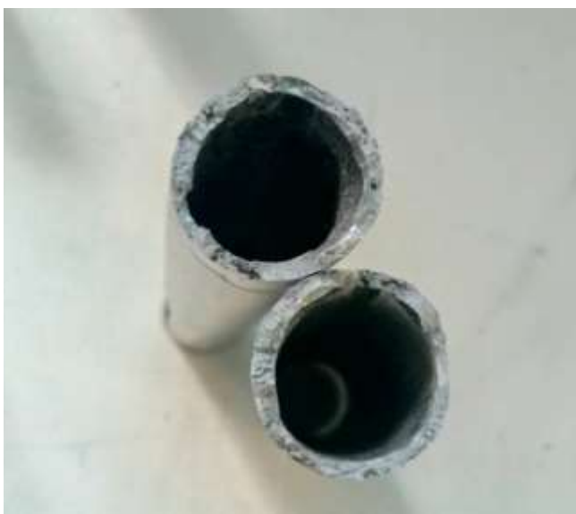
Figuras 16-20 Fractura tubería 1 con soldadura vista interna
