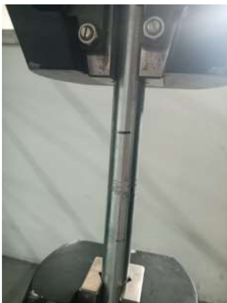
Figuras 16-19 Montaje tubería 1 con soldadura
