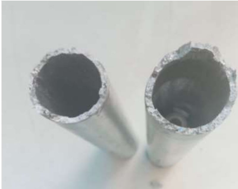
Figuras 16-37 Fractura tubería 4 con soldadura vista interna
