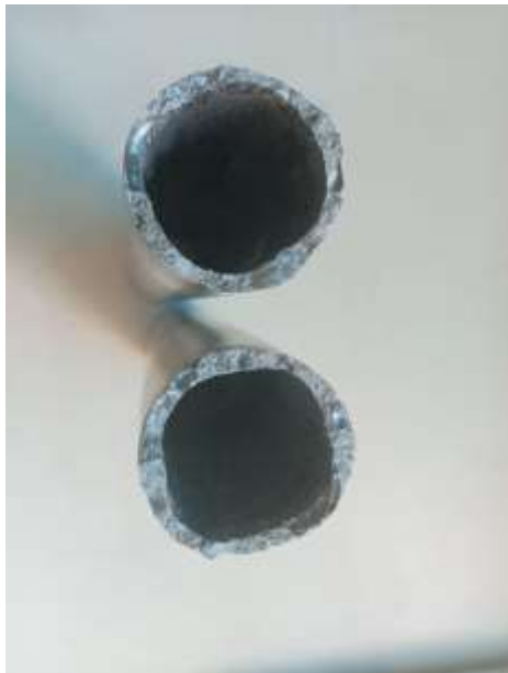
Figuras 16-26 Fractura tubería 2 con soldadura vista interna
