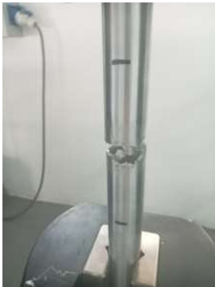
Figuras 16-36 Fractura tubería 4 con soldadura vista frente
