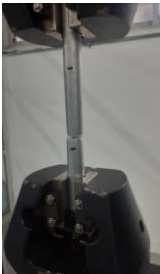
Figuras 16-43 Fractura tubería sin soldadura
