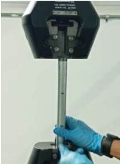
Figuras 16-42 Montaje tubería sin soldadura
