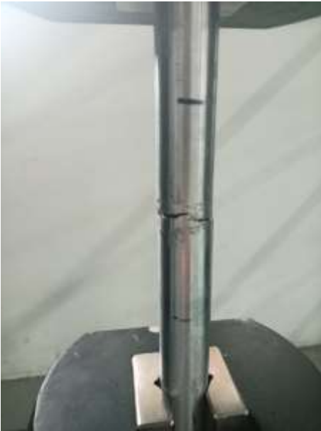
Figuras 16-30 Fractura tubería 3 con soldadura vista frente
