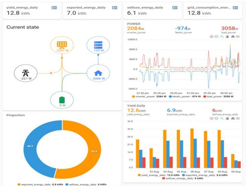
figura 6, dashboard sistema generación solar
