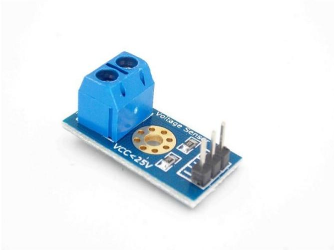
figura 12, sensor de voltaje
