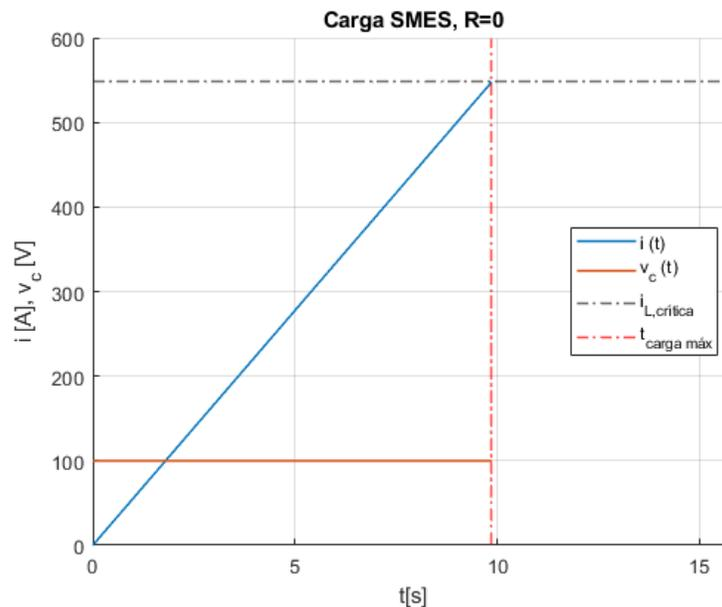
Figura 42. Carga de la SMES.  $i(t)$ ,  $V(t)$ .  $R_{coil}=0$ .
