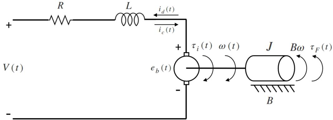
Figura 12. Emulación de Flywheel por máquina PMDC.
