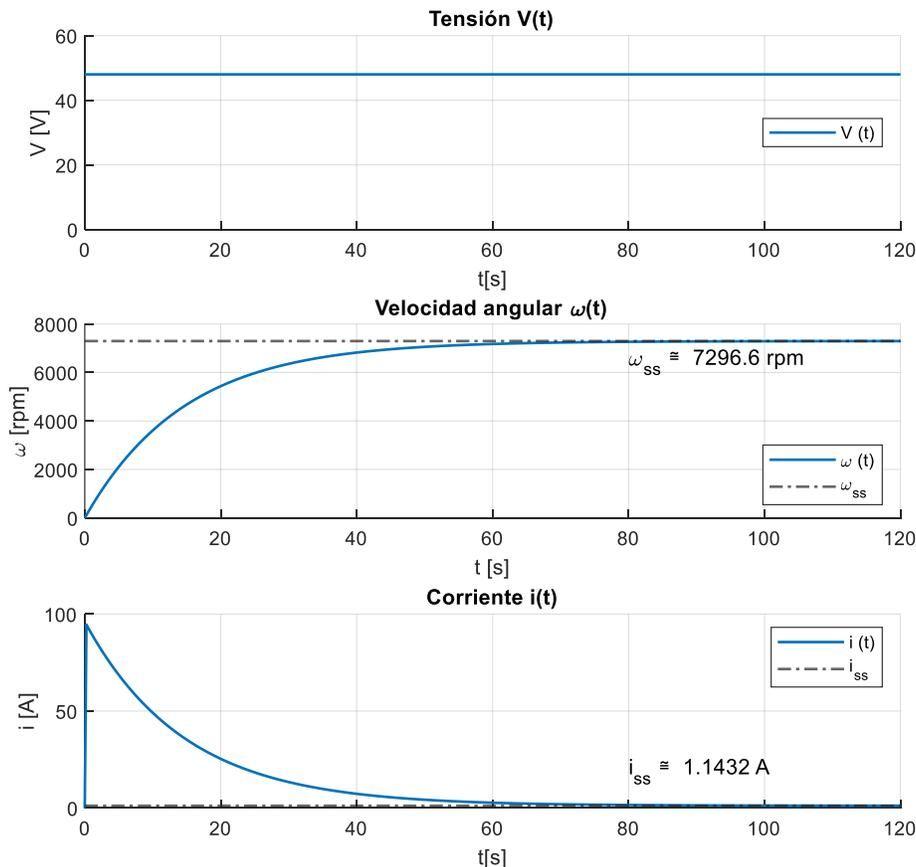
Figura 30. Carga y modo de almacenamiento Flywheel.
