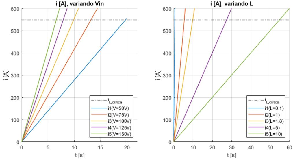
Figura 46. Variación de  $V_{in}$  y  $L_{coil}$  en el ciclo de carga de la SMES.  $R_{coil}=0$
