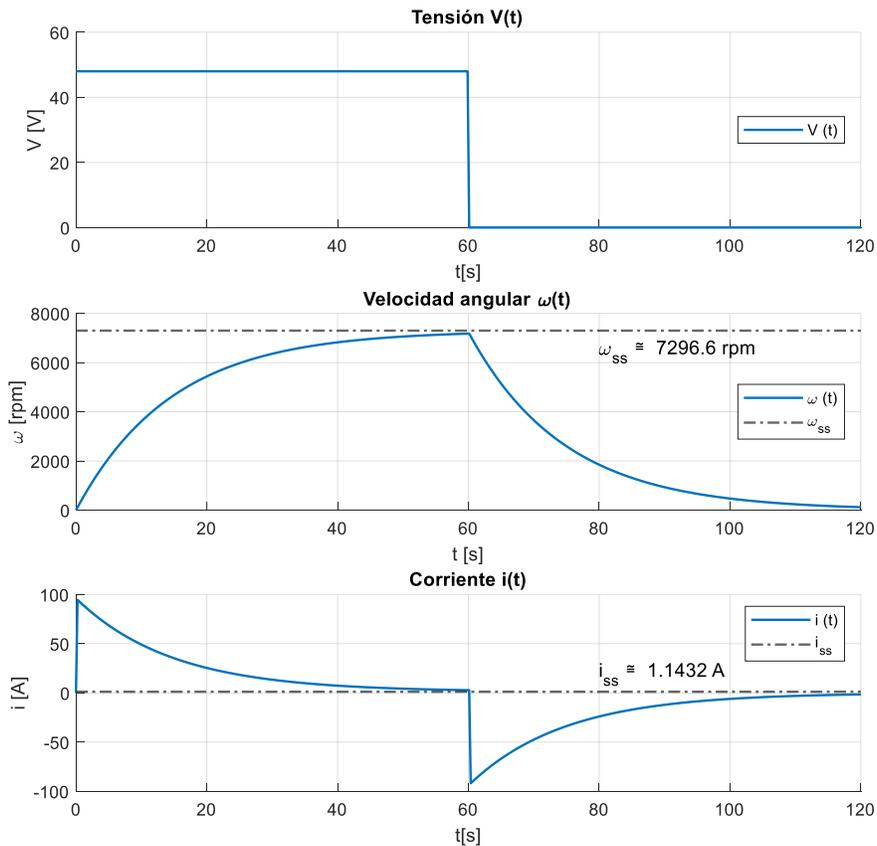
Figura 31. Autodescarga Flywheel con  $V(t) = 0$
