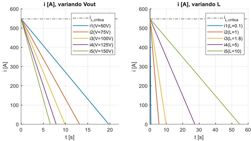
Figura 47. Variación de  $V_{out}$  y  $L_{coil}$  en el ciclo de descarga de la SMES.  $R_{coil}=0$
