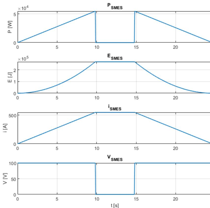
Figura 45. Carga, modo de almacenamiento y descarga SMES.  $R_{coil}=0$
