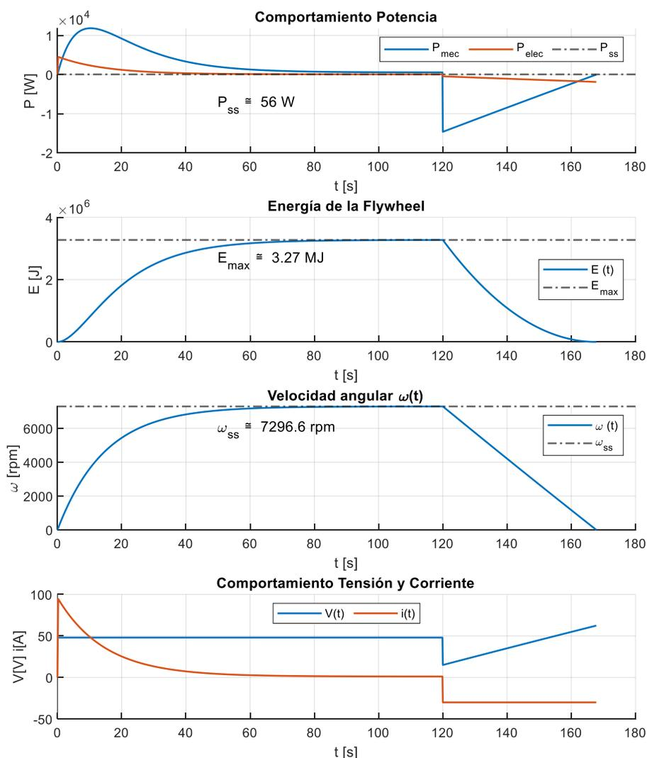
Figura 39. Carga, modo de almacenamiento y descarga a corriente constante Flywheel.  $i_{out} = 30$
