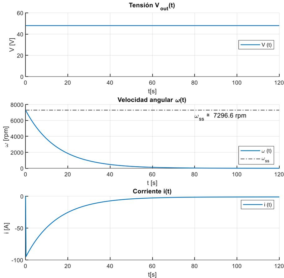
Figura 32. Descarga Flywheel a tensión constante  $V_{out} = 48 V$
