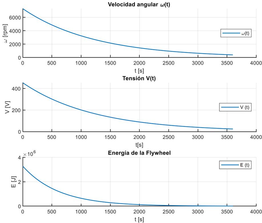
Figura 34. Autodescarga Flywheel con  $i(t) = 0$
