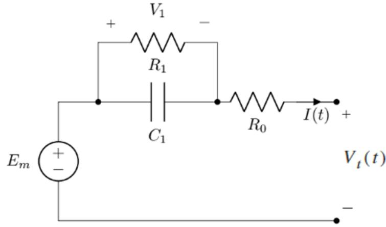
Figura 5. Circuito equivalente del modelo de Thévenin. Fuente: Nagi et al. (2019).
