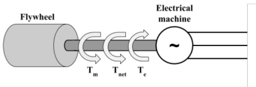
Figura 10. Esquema eléctrico del volante de inercia: equilibrio del torque en el sistema de almacenamiento de energía del volante. Fuente: Jan C. et al., 2020.
