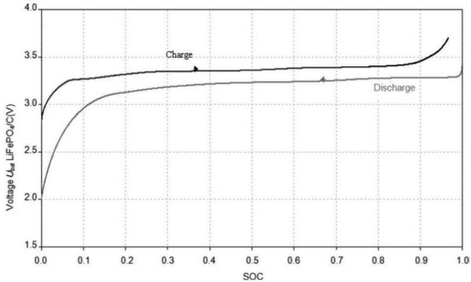
Figura 9. Histéresis de tensión entre carga y descarga a corriente constante ( $C/10$  durante la carga y la descarga) de un elemento C-LiFePO<sub>4</sub> de 10 Ah en función del SOC. Fuente: Glaize & Geniès (2013)
