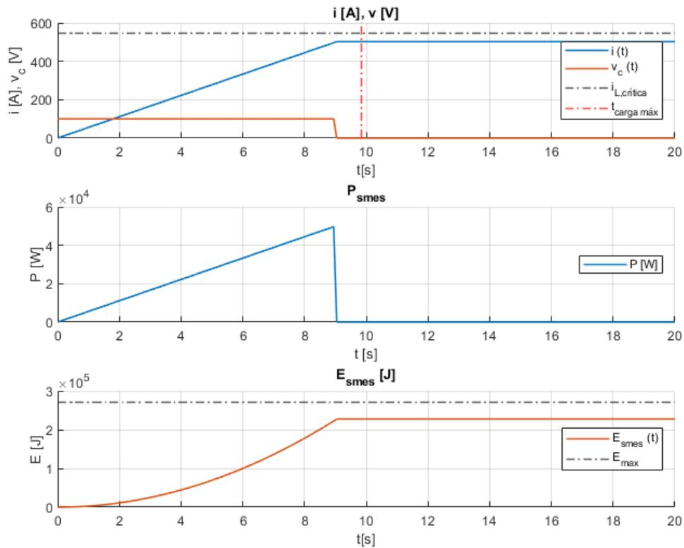
Figura 44. Carga y modo de almacenamiento SMES.  $i(t)$ ,  $V(t)$ ,  $P(t)$ ,  $E(t)$ .  $R_{\text{coil}}=0$
