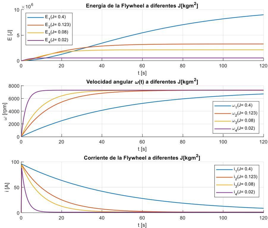
Figura 40. Carga Flywheel con variacion de  $J$ .  $V_{in} = 48V$  constante
