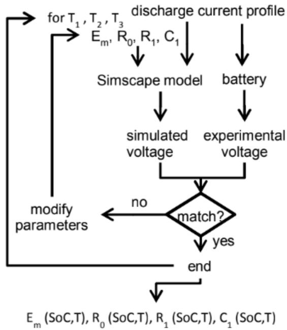
ANEXO C. Módulo de optimización de parámetros y de simulación de una celda de batería LiIon.
