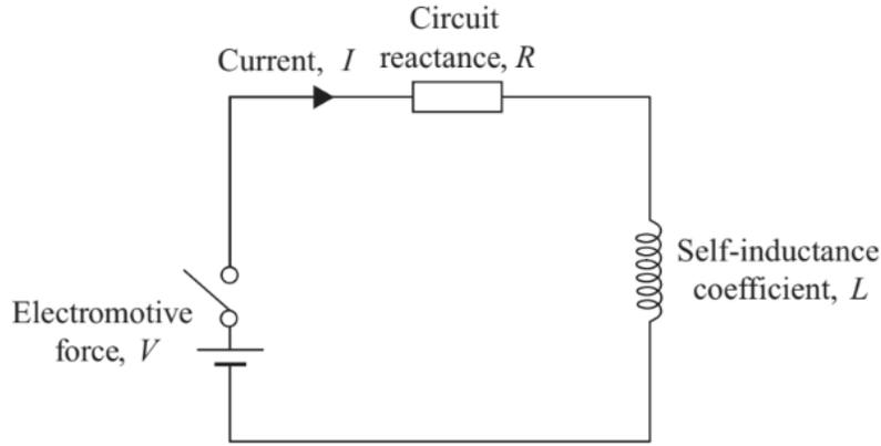
Figura 14. Circuito RL en serie equivalente a un diagrama simplificado de un SMES. Fuente: Ter-Gazarian, 2020.
