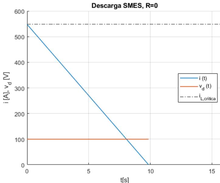
Figura 43. Descarga de la SMES.  $i(t)$ ,  $V(t)$ .  $R_{coil}=0$ .
