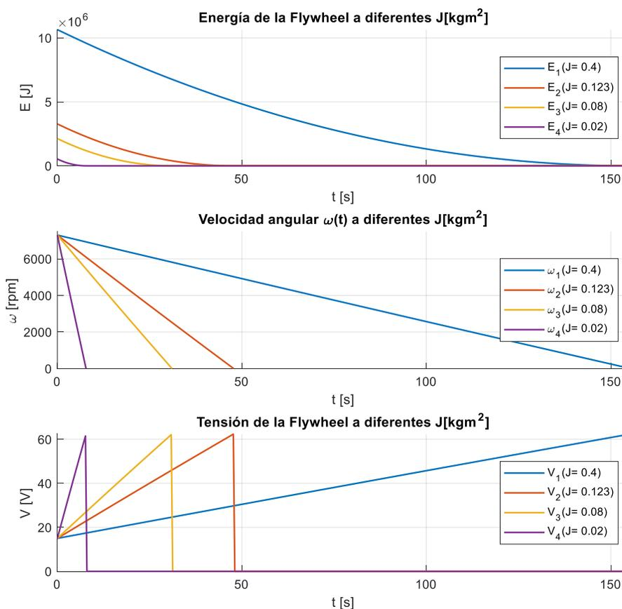
Figura 41. Descarga Flywheel con variación de  $J$ .  $i_{out} = 30$  constante
