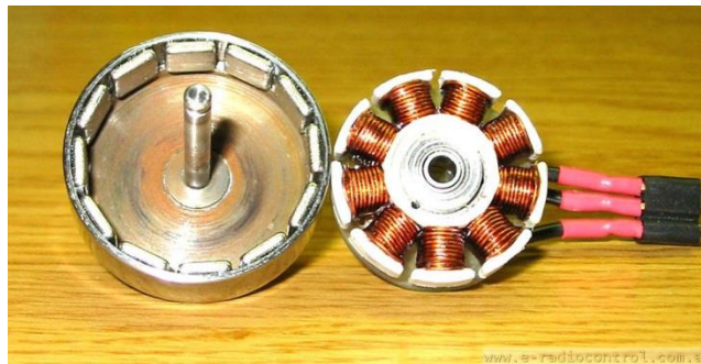
Figura 19 Detalle del rotor y estator de un motor brushless
