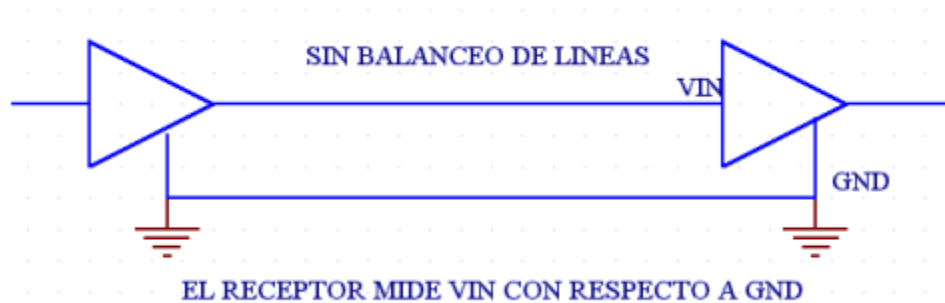
Figura 50 Línea no balanceada
