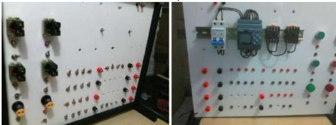
**Figura 17.** Montaje de los dispositivos de control en el tablero de acrílico.
