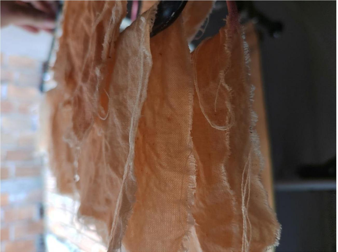
*Ilustración 55 Muestra de secado al sol para solidez de color y resistencia textil.*
