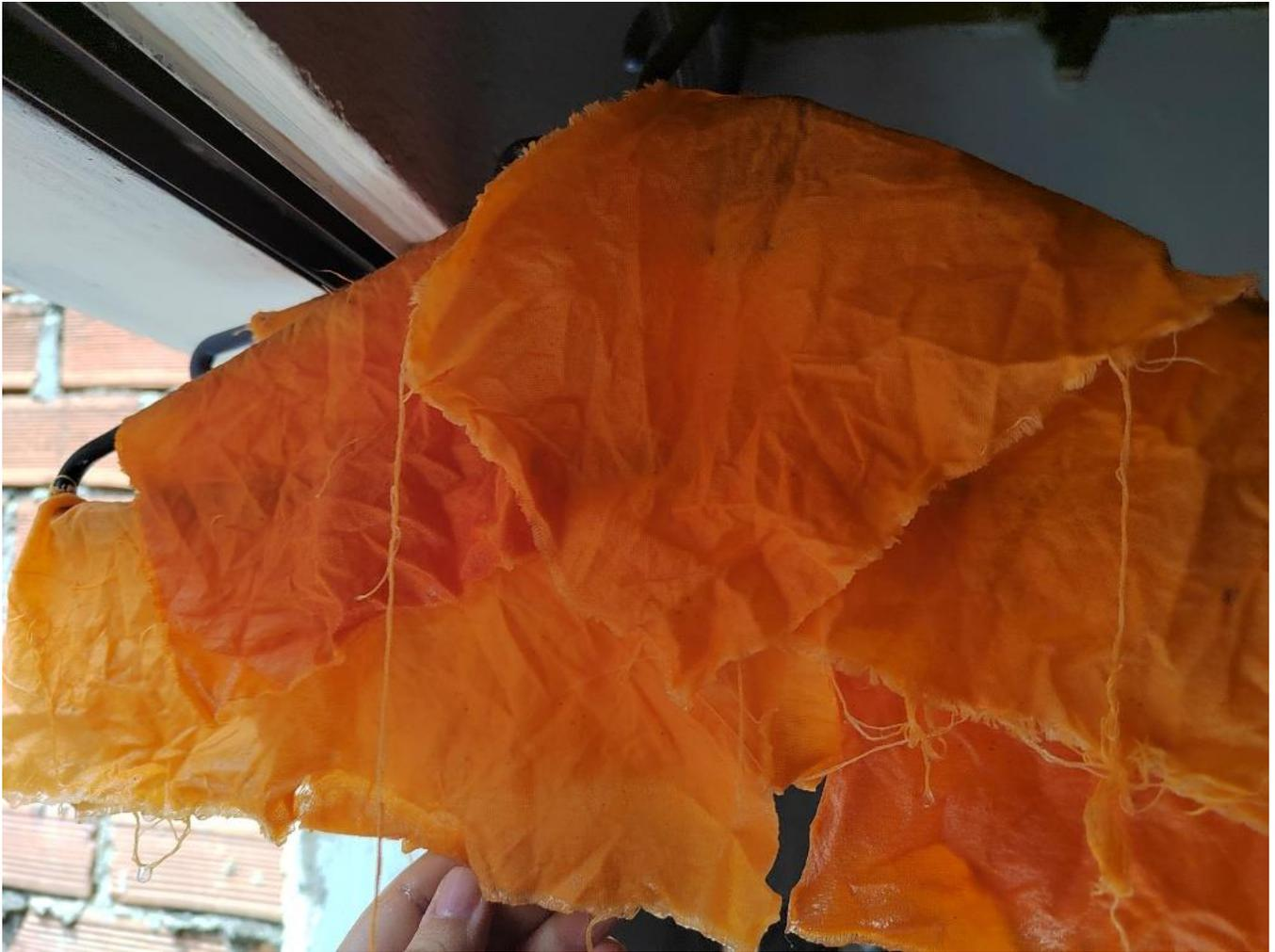
*Ilustración 56 Muestra de secado al sol para solidez de color y resistencia textil.*
