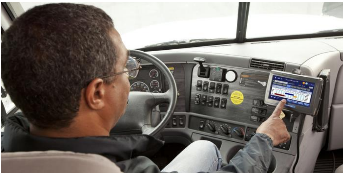
Ilustración 56. Sistema ELD dentro de la cabina de mando de una empresa transportadora de cargas. (Birkland, 2014)
