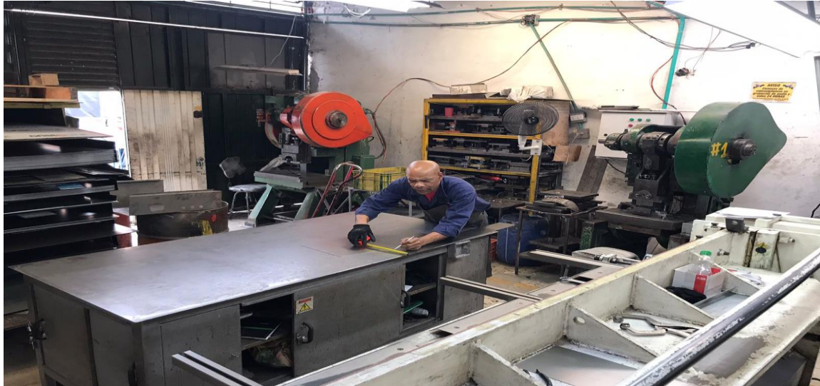
Ilustración 43 Troqueladoras grandes con la estantería de troqueles en la bodega del frente
