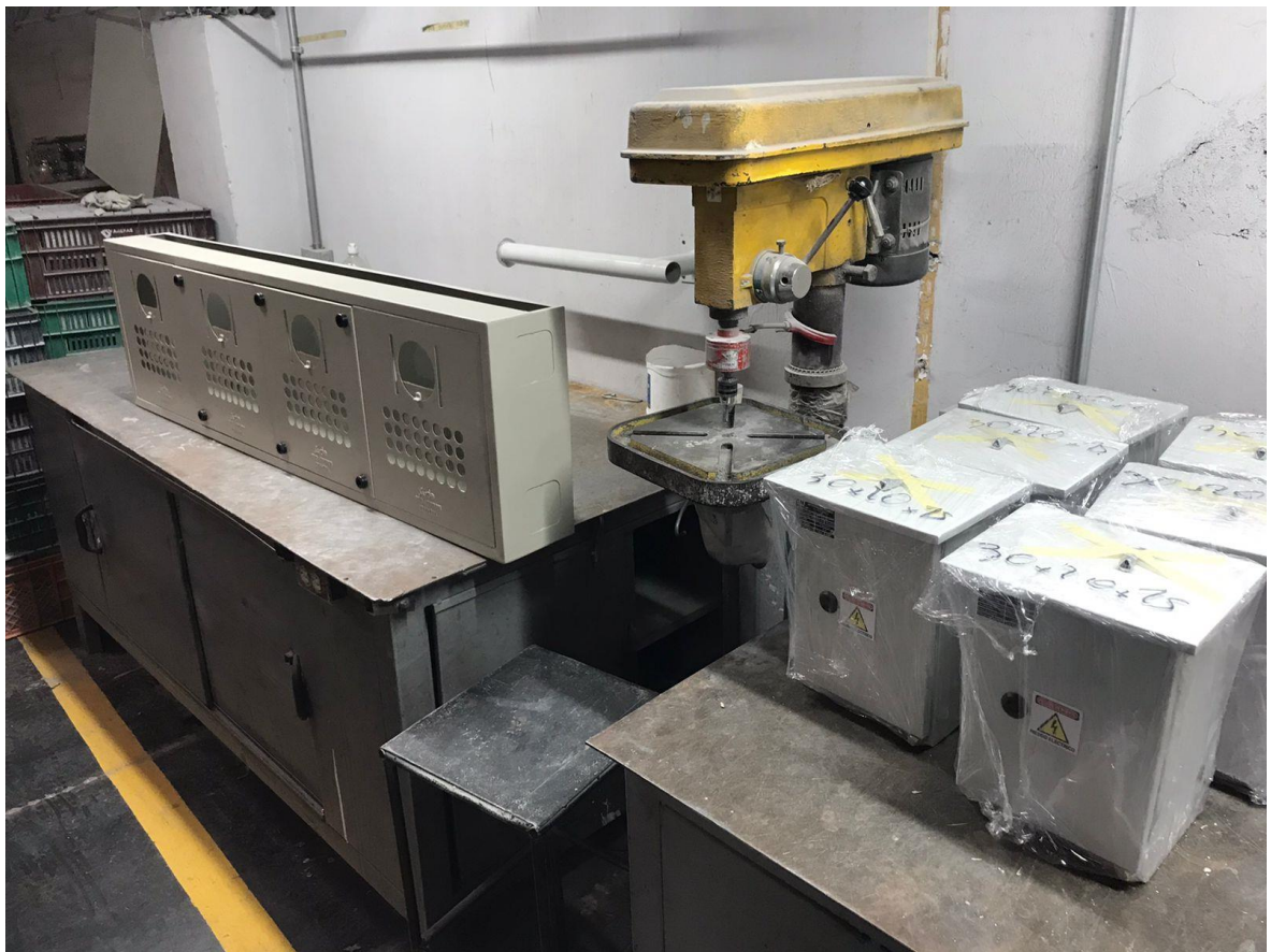
Ilustración 22 Ensamble de cajas 12x12 y gabinetes de gas
