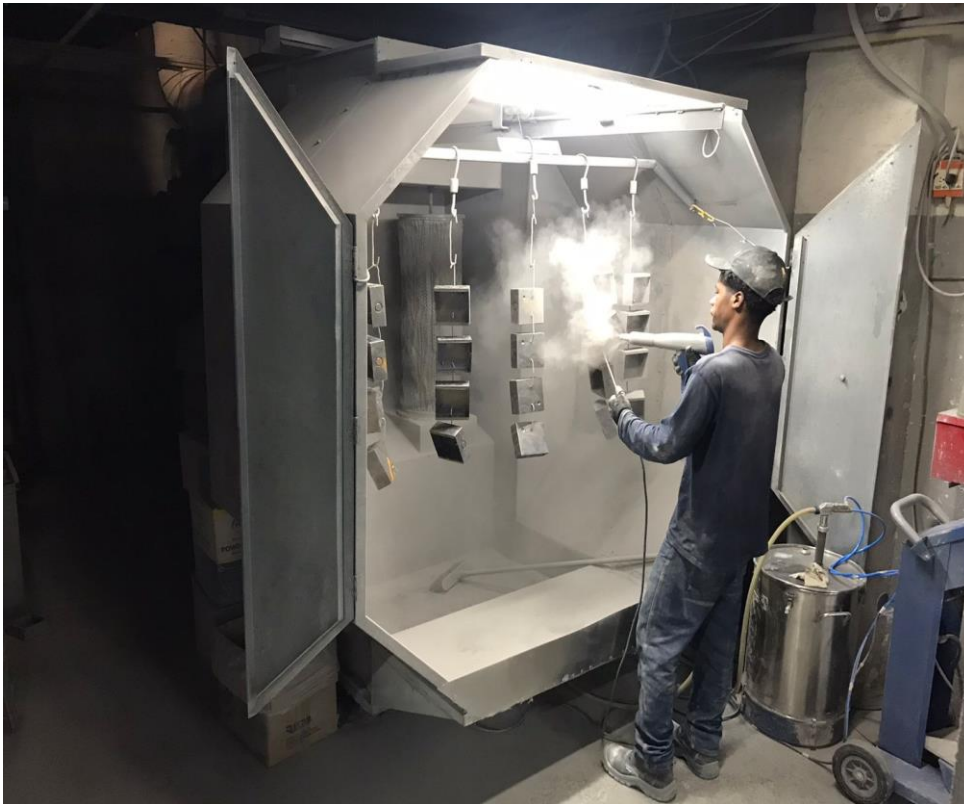
Ilustración 19 Cabina de pintura pequeña
