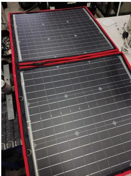
*Figura 22.* Panel solar plegable Dokio 80W – 12V monocristalino
