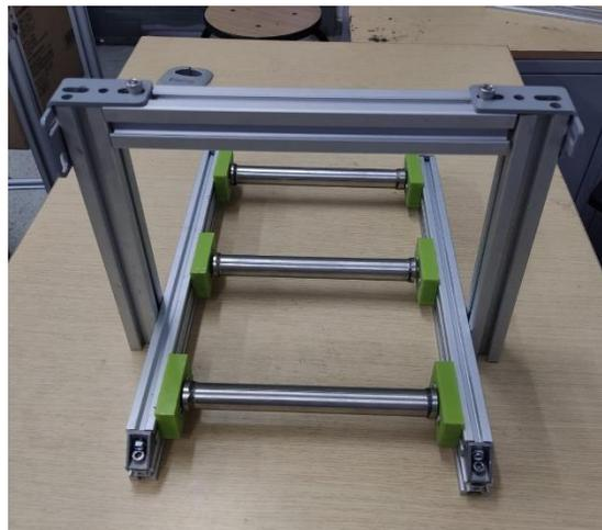
*Figura 15.* Riel/Deslizador anclado a la banda transportadora
