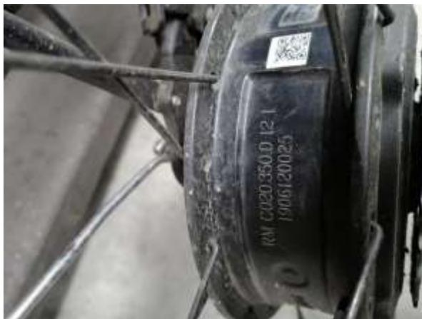
*Ilustración 10 Motor eléctrico bafang GW referencia RWCO20350D121
