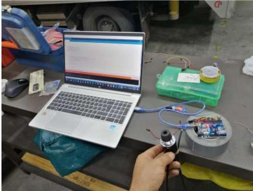
Ilustración 25 Montaje Rotary encoder
