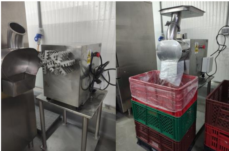
Ilustración 32. Máquina desmechadora semi industrial
