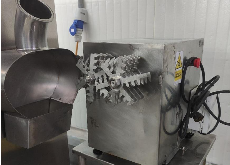
Ilustración 5. Cuchilla máquina desmechadora
