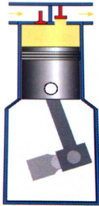
Figura 6. Compresor recíprocante de una etapa.
