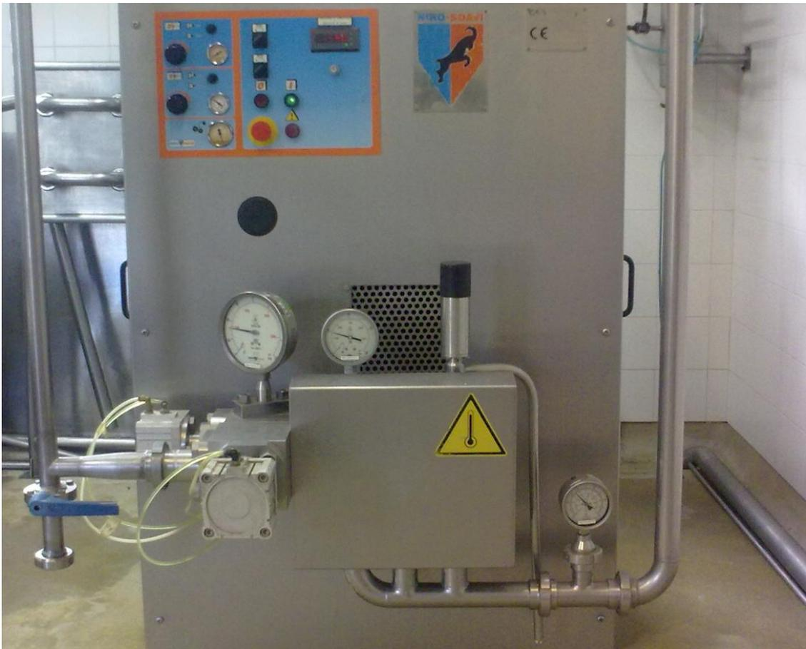
Anexo F. Tubería agua potable para pistones del homogeneizador desde la red principal
