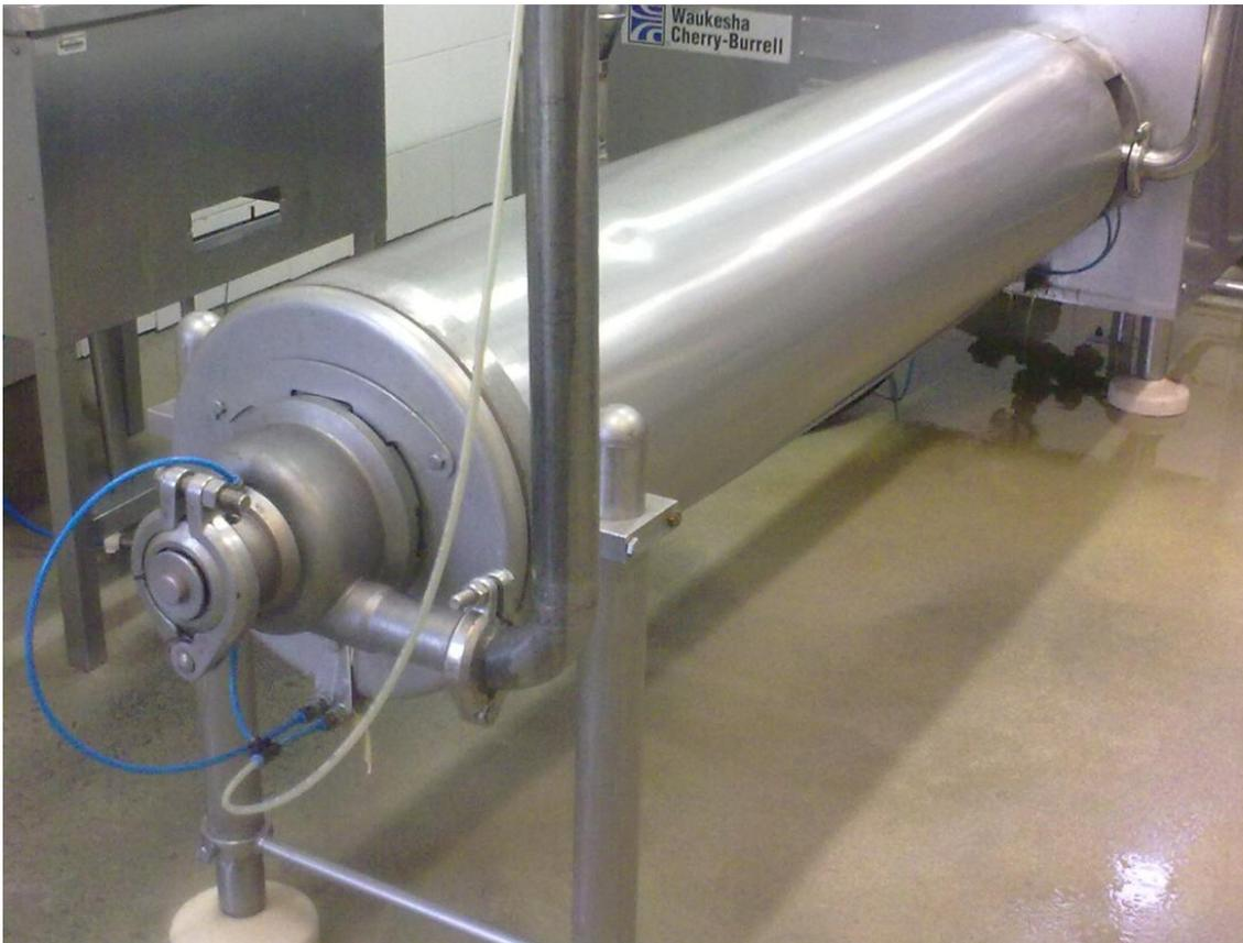
Anexo I. Tubería del agua para sellos del calentador y bomba de alimentación
