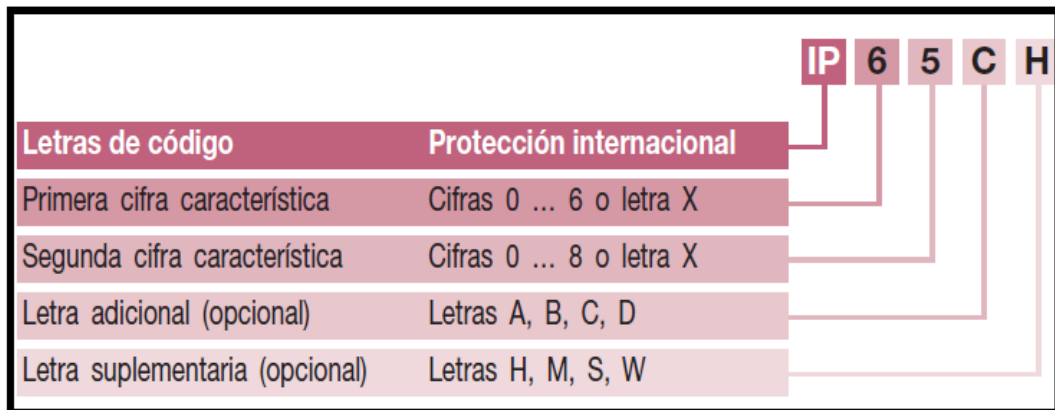
Figura 7. Esquema código de protección IP.
