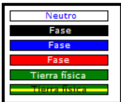
Figura 30. Código de colores en conductores
