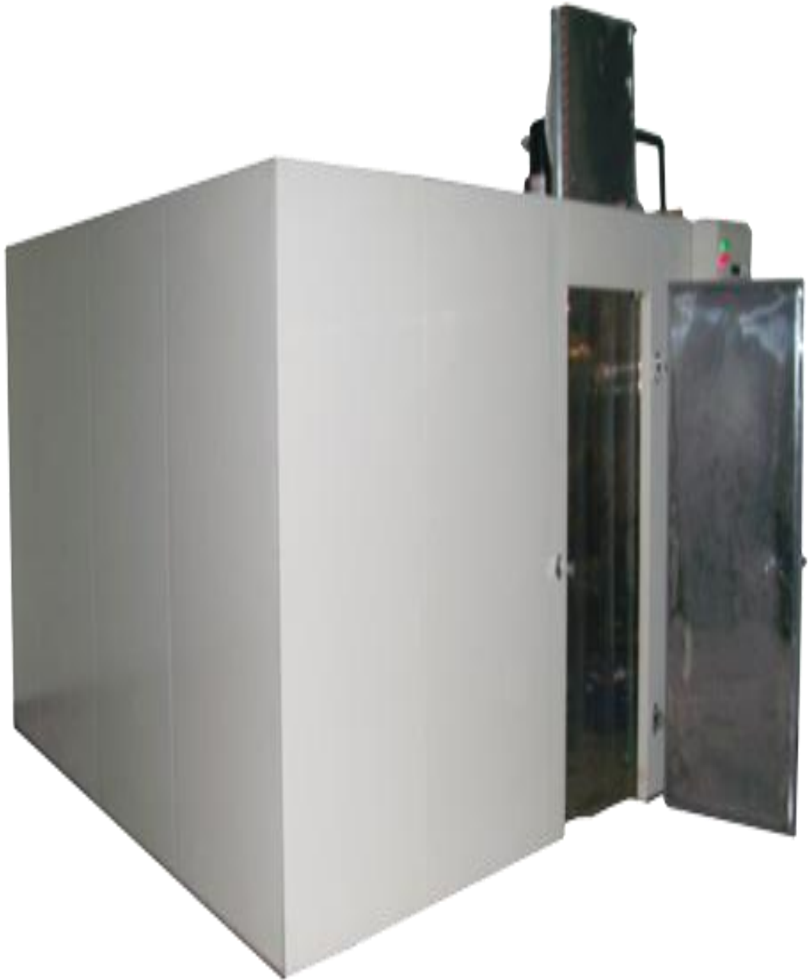
Figura 10. Cuarto de refrigeración terminado.
