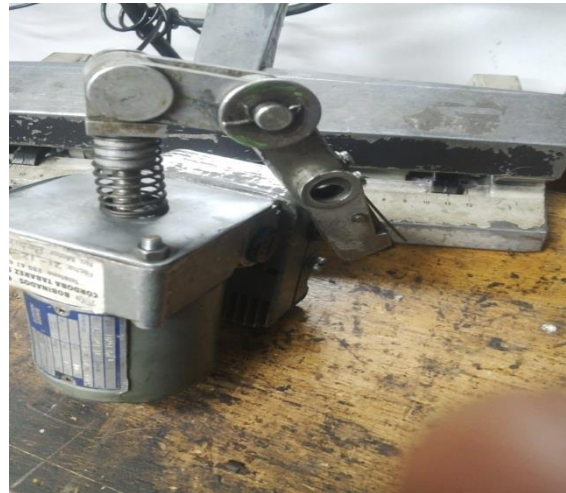
Figura 16. Solenoide y palanca de freno
