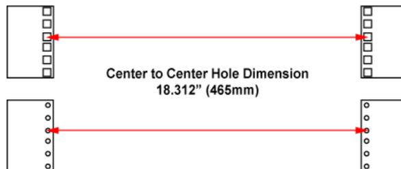
La abertura entre filas verticales del bastidor se especifica como un mínimo de 17,72" (450 mm). En bastidores con orificios roscados tiende a ser más grande la abertura entre filas verticales mientras que en bastidores de agujeros cuadrados
