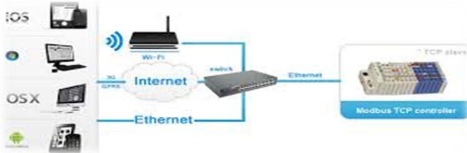
Figura 17. Comunicación Ethernet.
