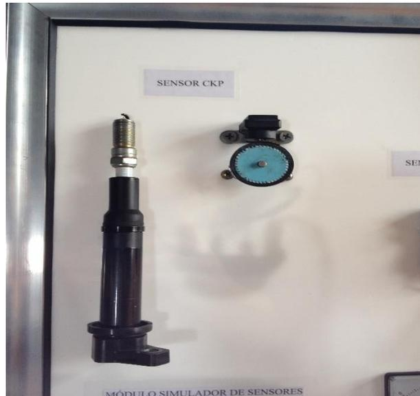
*Figura 5.* Estructura física del sensor CKP
