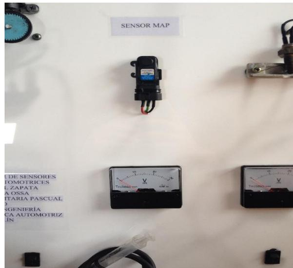
*Figura 7.* Estructura física del sensor MAP
