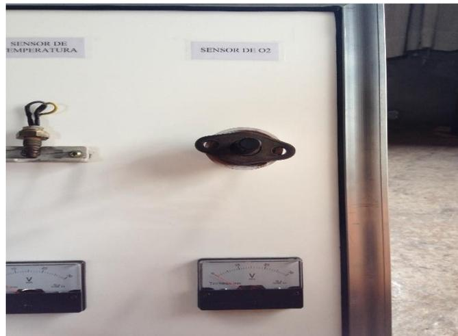
*Figura 11.* Estructura física frontal del sensor de oxígeno
