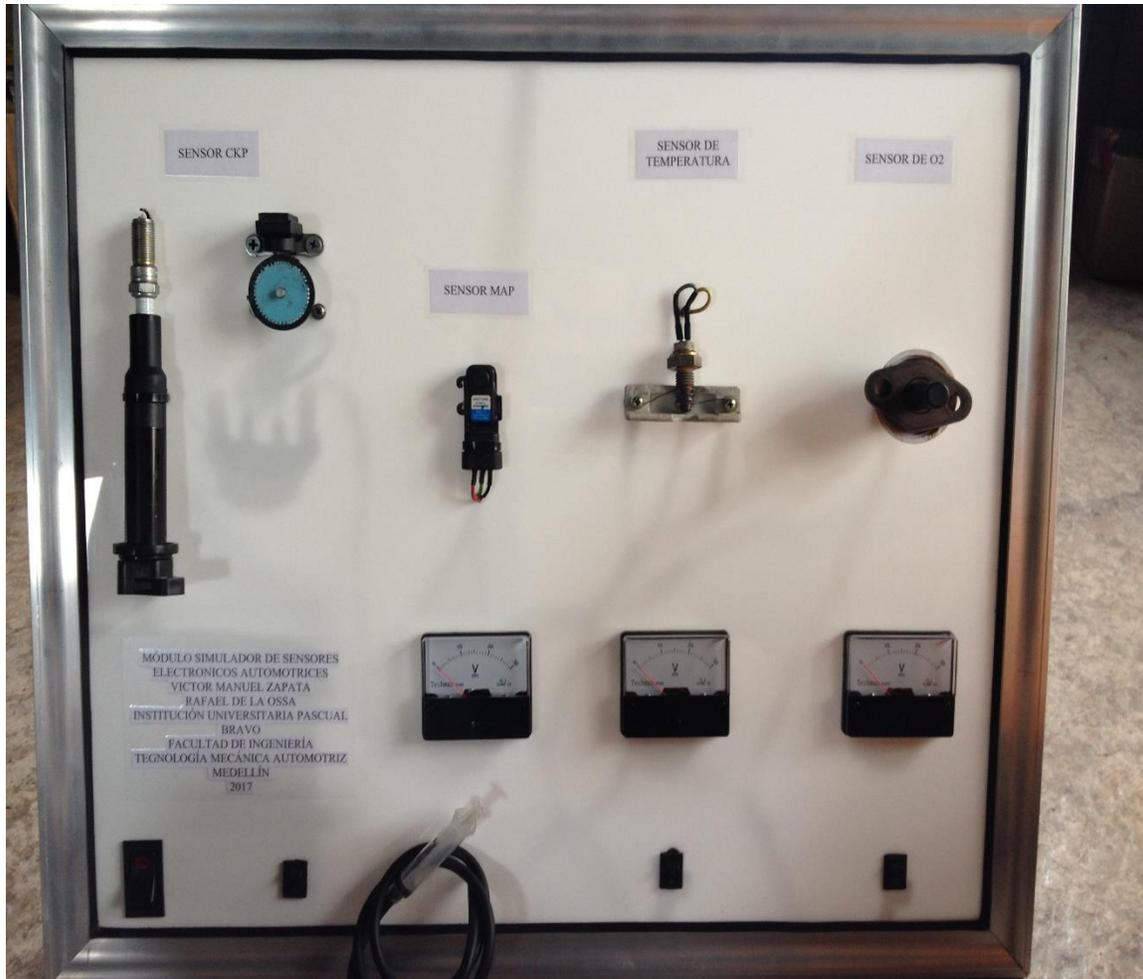
*Figura 13.* Módulo simulador d sensores eléctricos automotrices
