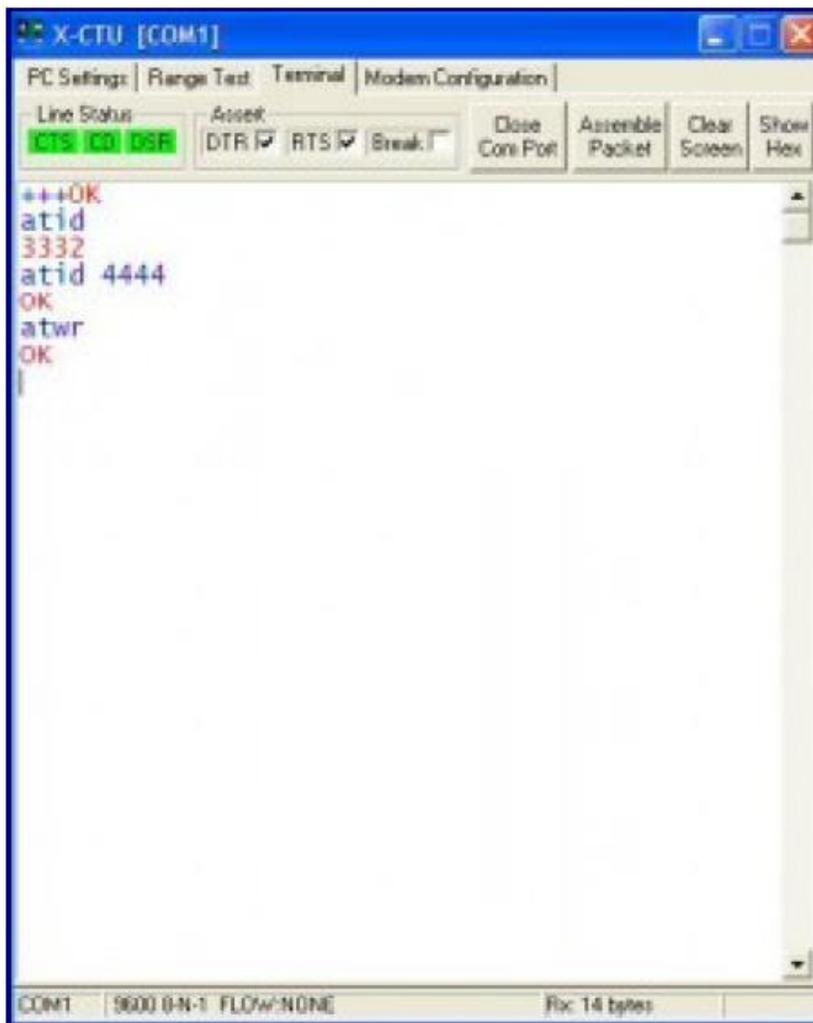
Figura 8. Configuración del xbee por medio de modem configuration.
