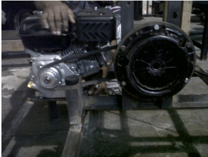
Foto 14 Vista frontal de la adaptación del sistema de clutch
