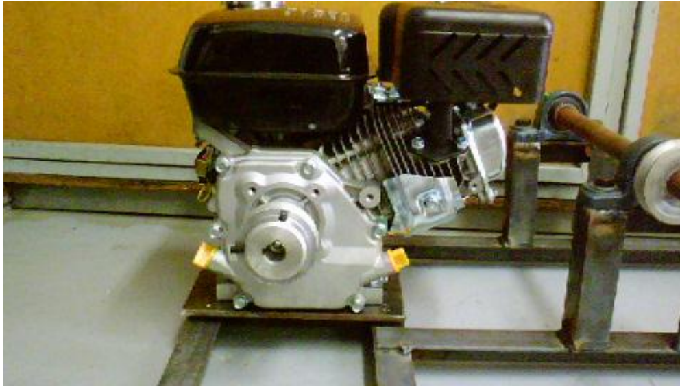
Foto 23 Alineando base de motor
