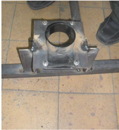
Foto 38 Base para palanca de cambios
