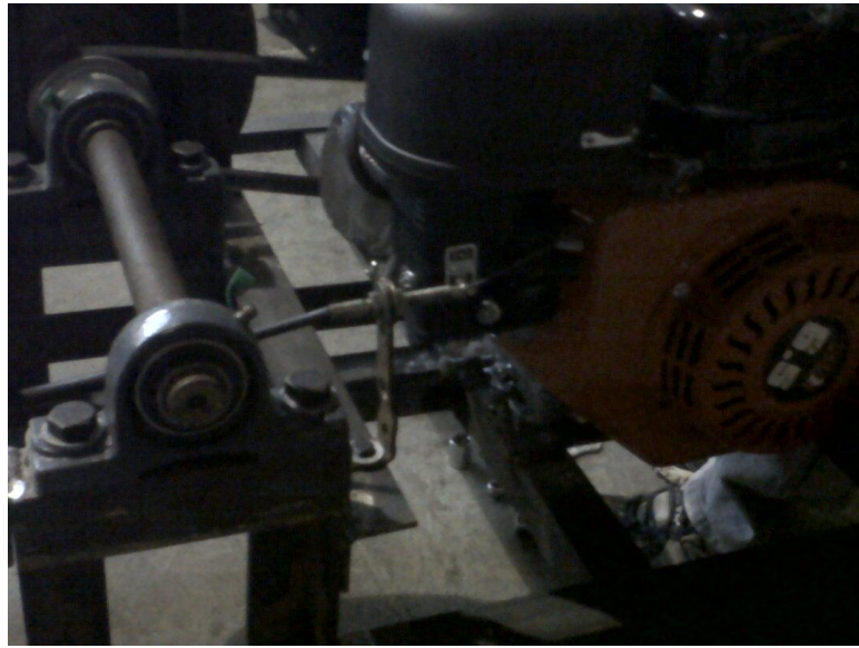
Foto 11 Pie amigo para accionar el acelerador
