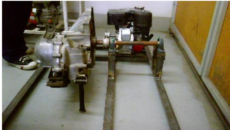
Foto 16 Nivelando la caja con el motor
