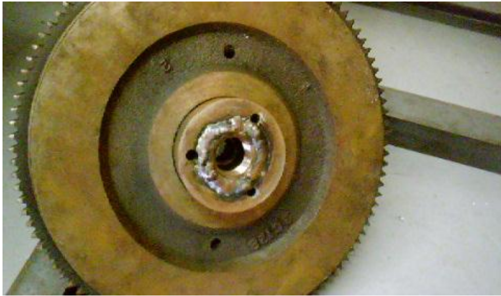
Foto 25 Modificada de volante con una Longitud de rosca 1" y 1/2"
