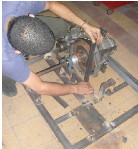
Foto 40 Calculando e instalando bases para caja de velocidades
