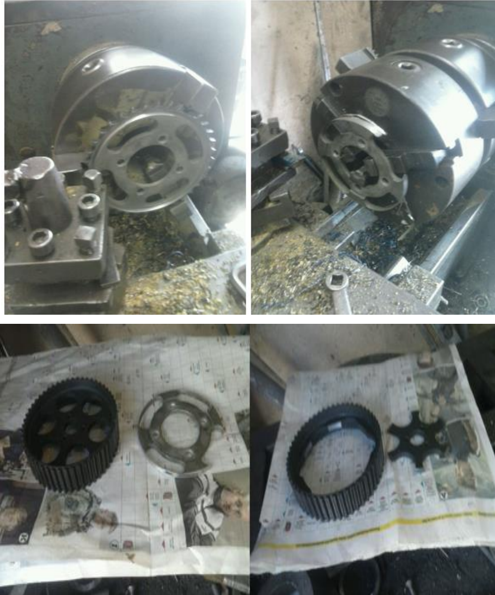
Ilustración 24. Proceso de corte y maquinado piñón secundario. Fuente. Propia
