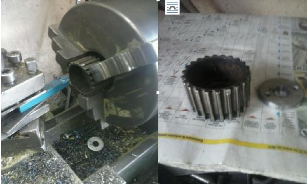
Ilustración 22. Proceso de corte y maquinado piñón primario. Fuente. Propia.
