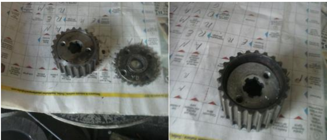
Ilustración 23. Polea primaria terminada. Fuente. Propia.
