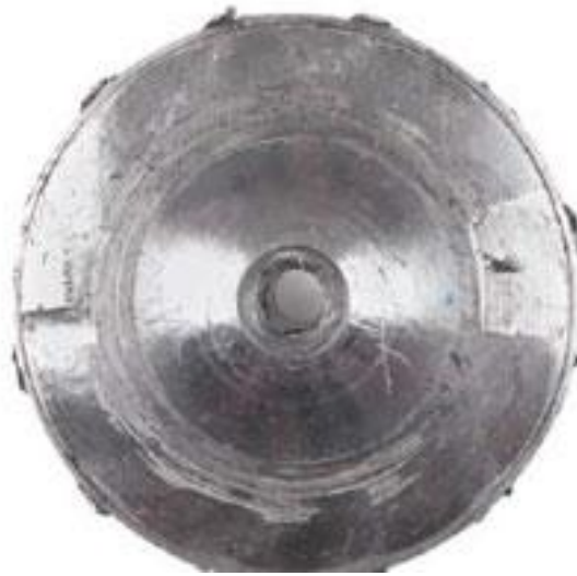
Figura 28. Rueda del compresor partida
