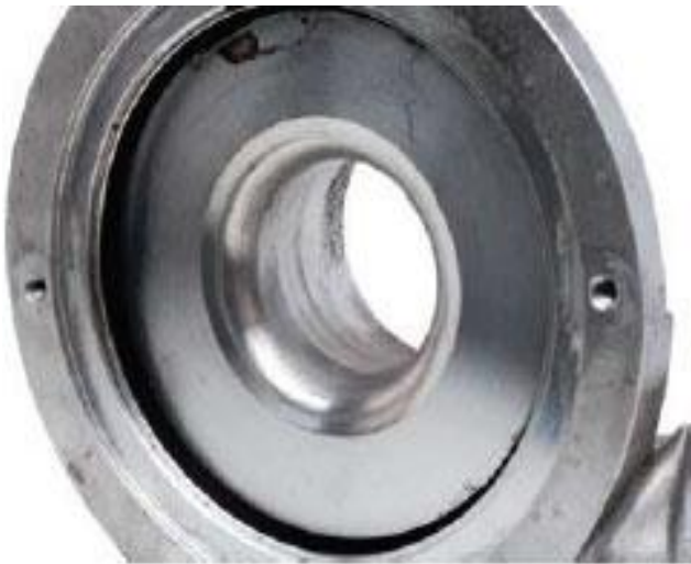
Figura 15. Marcas de fricción en la carcasa de compresor
