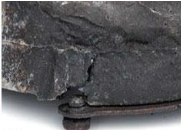
Figura26. Fisura en la carcasa de la turbina
