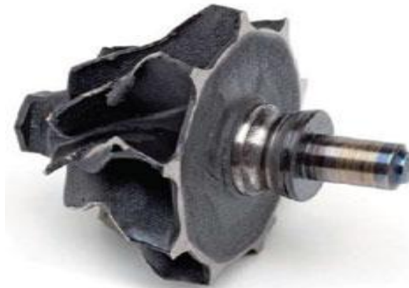
Figura 17. Vástago de eje fracturado
