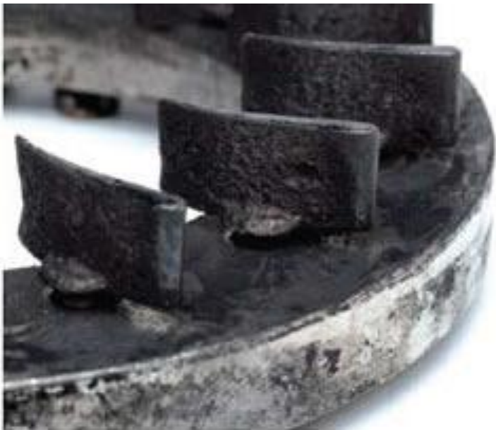
Figura 23. Rueda de compresor dañada
