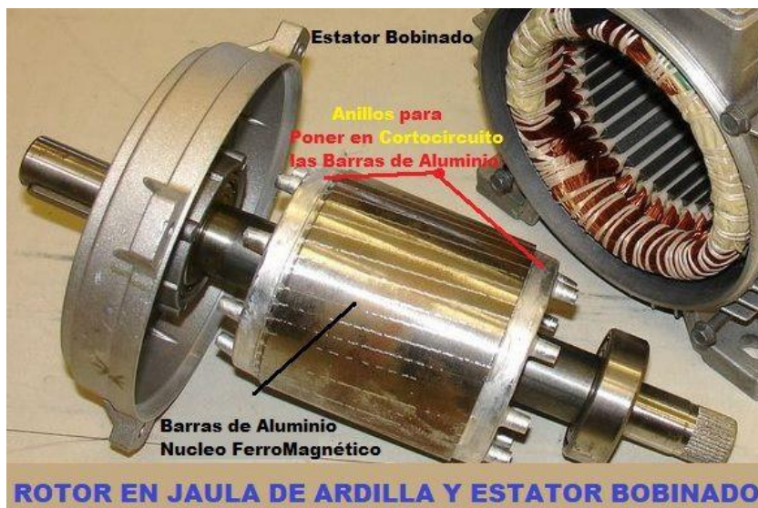
Figura 14. Rotor Jaula de Ardilla
