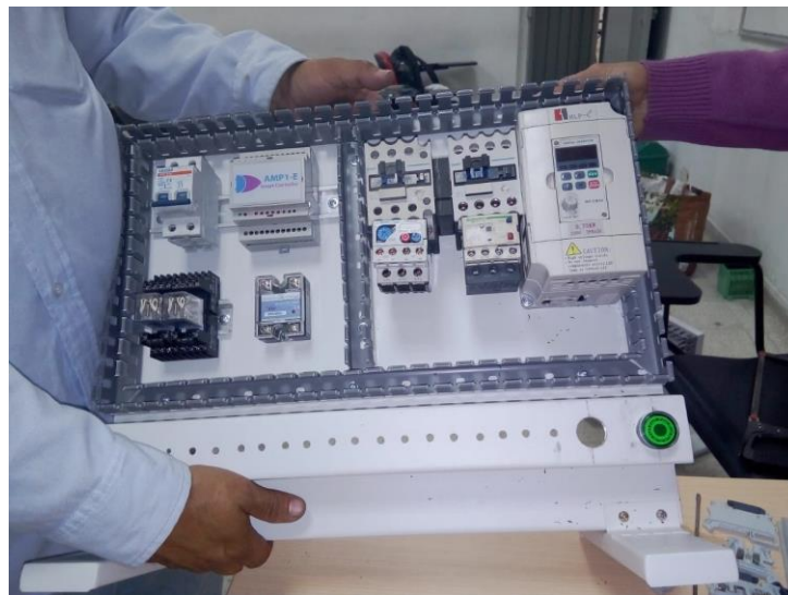
Figura 21. Tablero con Componentes Fijados Foto tomada por: Jeison Andrés vidal.
