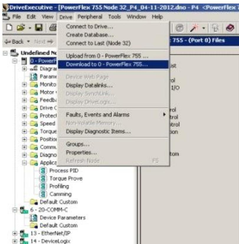
Figura 22 descargar programa a variador (paso 1)
