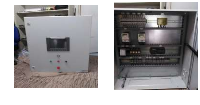
Figura 1. PLC, Touch frontal Y PLC, Circuitería interna Fuente: extraído de Griccoat S.A.
